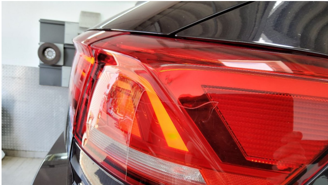
Rückleuchte rechts aussen zerkratzt - erneuern - erneuern Rückleuchte rechts aussen zerkratzt (DEKRA)
