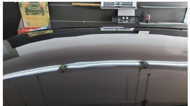
Dach, eingedellt - drücken - drücken Dach, eingedellt, drücken (DEKRA)
