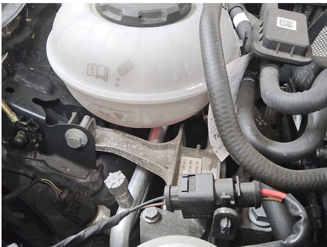
Kühlmittelstand unter minimum prüfen
