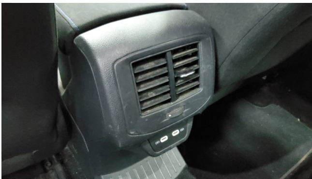
Luftausströmer hinten Mitte Verstellung beschädigt - erneuern - erneuern Luftausströmer hinten Mitte Verstellung beschädigt (DEKRA)
