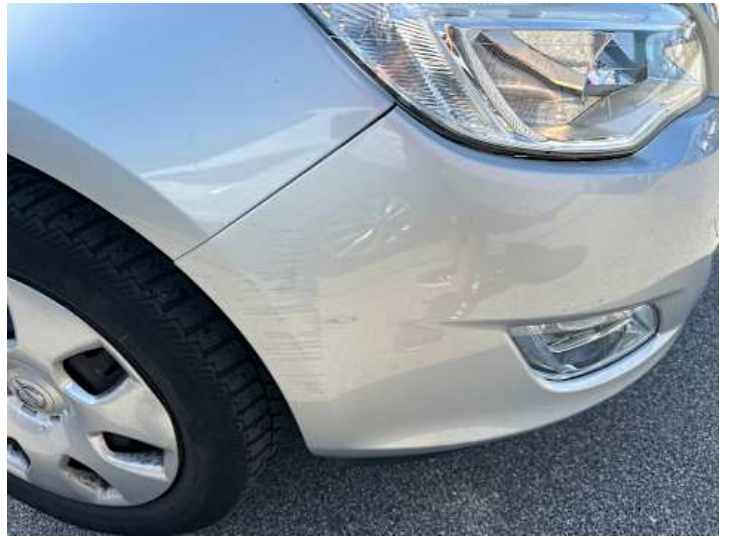
Stoßstange vorne (Lackschaden, Kratzer)
