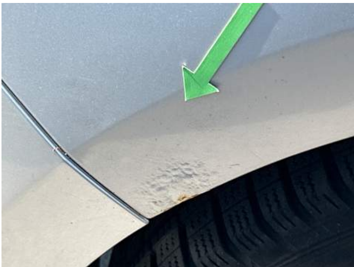
Seitenteil hinten rechts (Rost)
