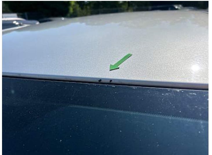
Dach (Lackschaden, Rost)
