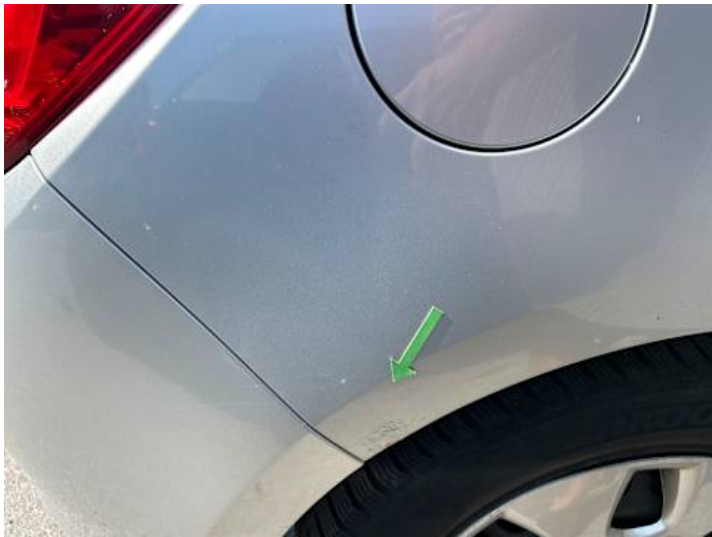
Seitenteil hinten rechts (Rost)
