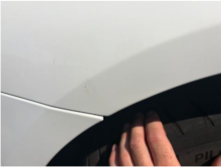
Seitenteil hinten rechts (Steinschlag)
