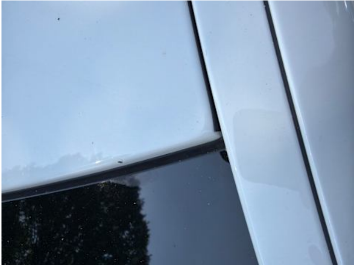
Dach (Steinschlag, Lackschaden)
