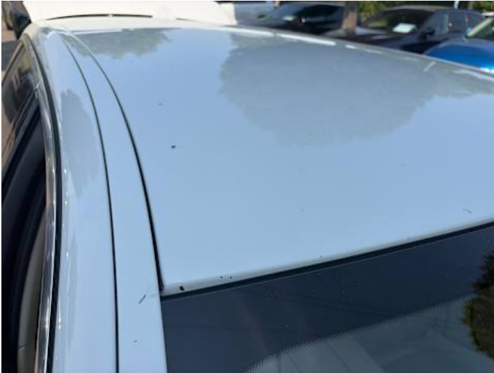
Dach (Steinschlag, Lackschaden)
