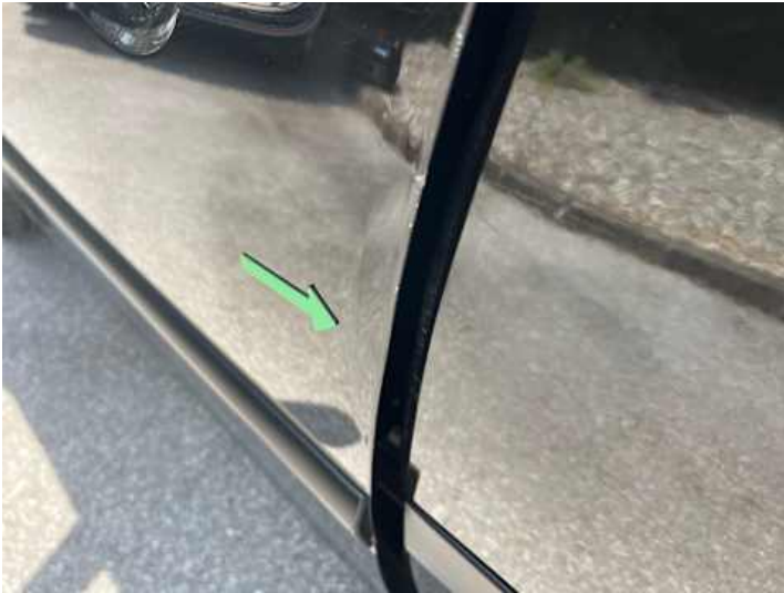
Fahrtür (Lackschaden, Verformung)
