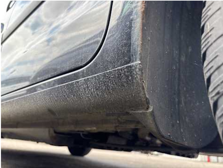
Schweller links (Rost)
