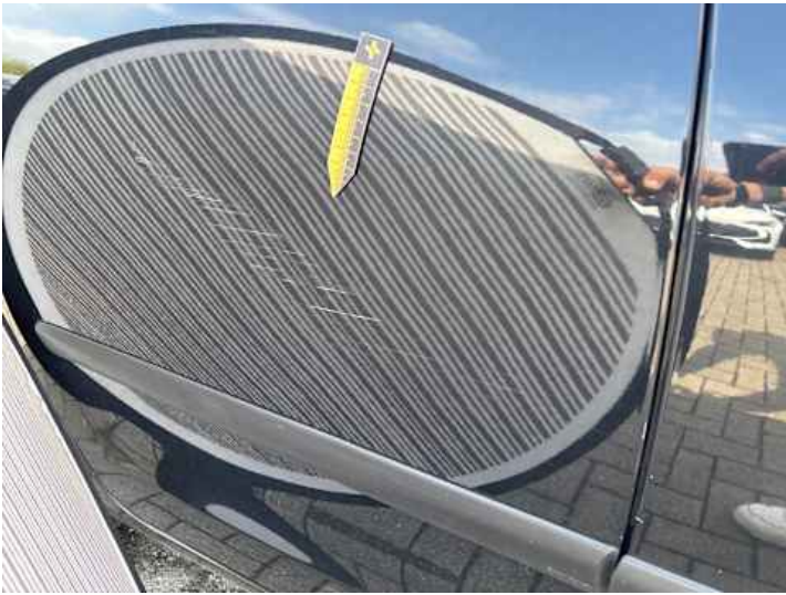
Türe hinten rechts (Lackschaden, Verformung)
