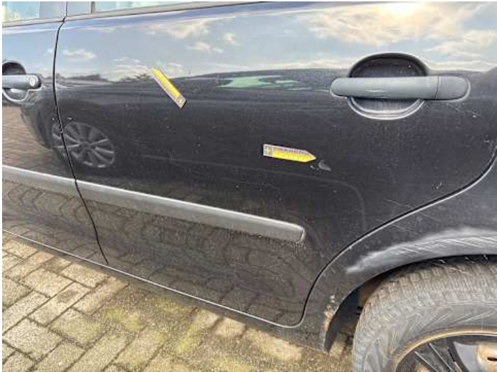
Türe hinten links (Delle, Kratzer, Lackschaden)
