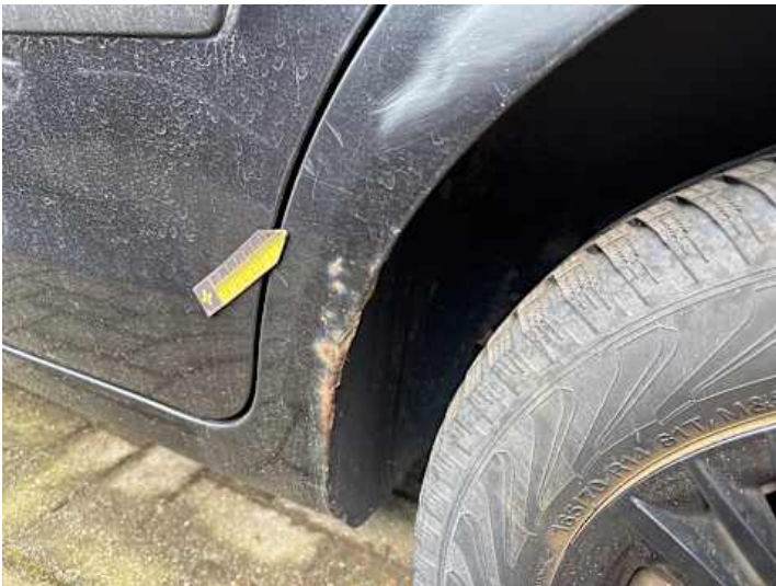
Seitenteil hinten links (Delle, Lackschaden, Kratzer, Rost)
