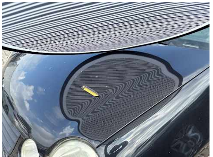
Motorhaube (Delle, Kratzer, Lackschaden)
