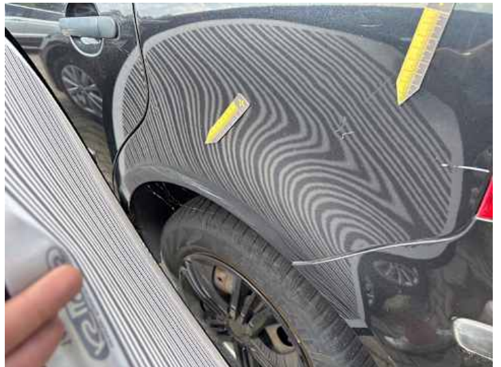
Seitenteil hinten links (Delle, Lackschaden, Kratzer, Rost)
