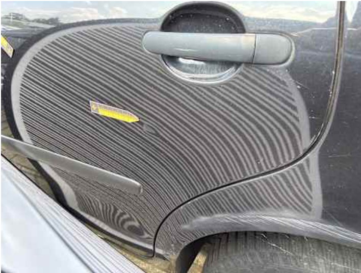
Türe hinten links (Delle, Kratzer, Lackschaden)
