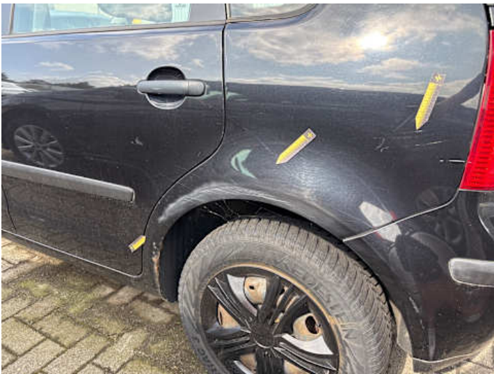
Seitenteil hinten links (Delle, Lackschaden, Kratzer, Rost)
