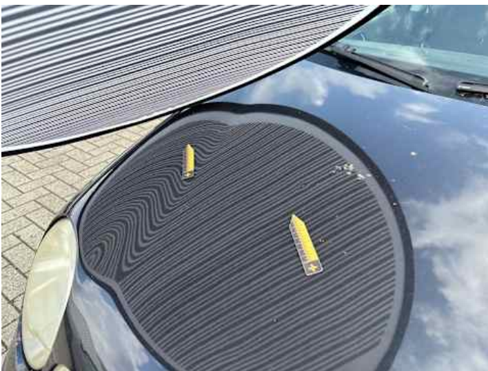
Motorhaube (Delle, Kratzer, Lackschaden)
