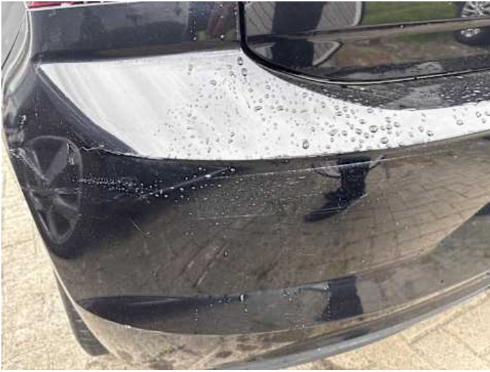
Stoßstange hinten (Kratzer)
