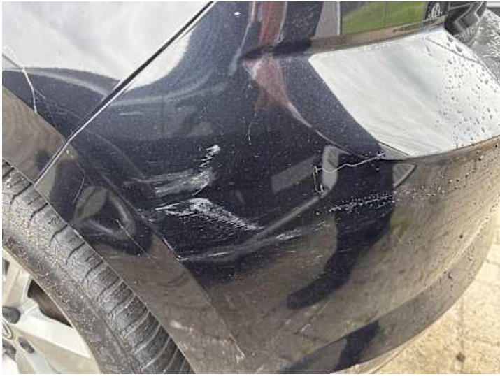
Stoßstange hinten (Kratzer)
