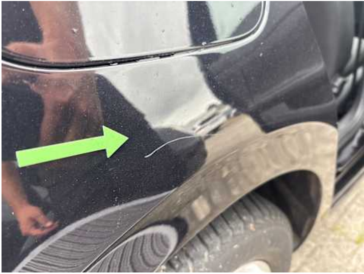
Seitenteil hinten rechts (Kratzer)
