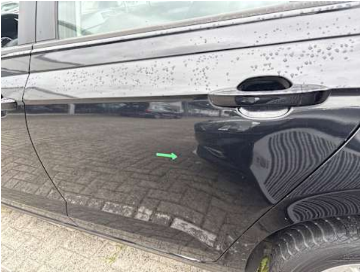
Türe hinten links (Delle)
