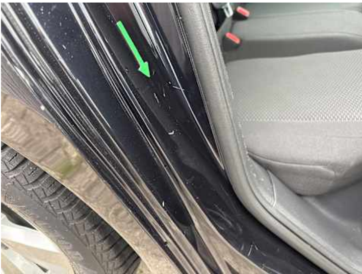
Seitenteil hinten rechts (Kratzer)
