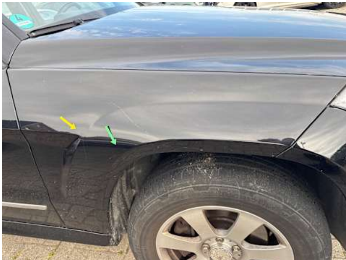
Kotflügel vorne rechts (Kratzer)
