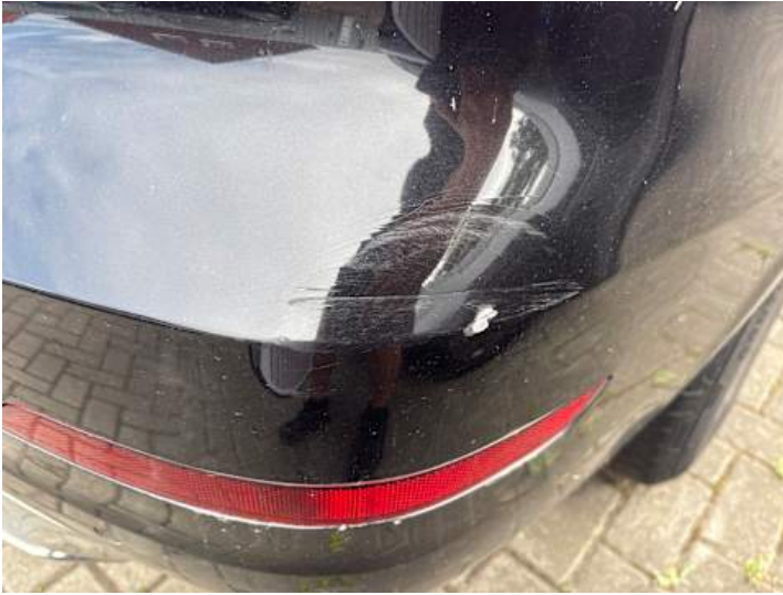
Stoßstange hinten (Kratzer, Verformung)
