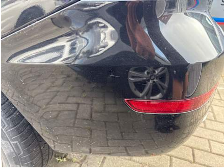
Stoßstange hinten (Kratzer, Verformung)
