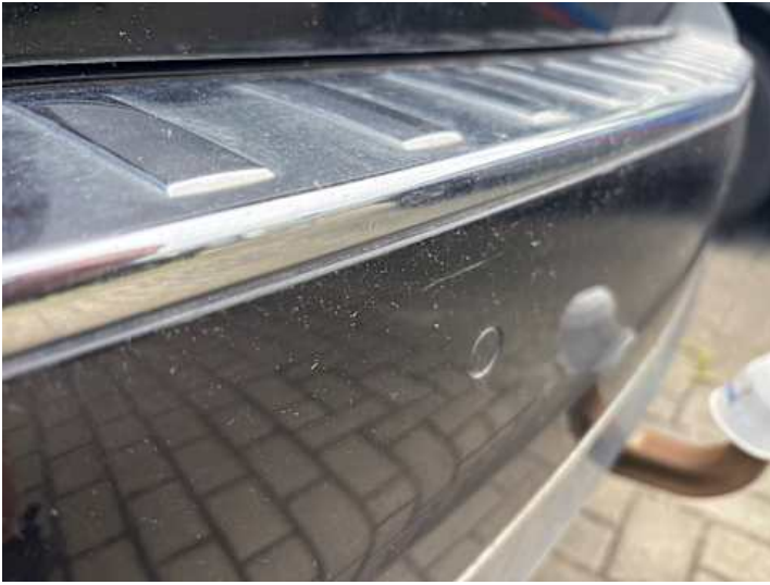
Stoßstange hinten (Kratzer, Verformung)
