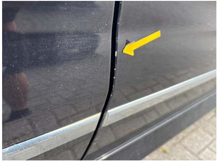
Beifahrertür (Riss/Bruch, Kratzer)
