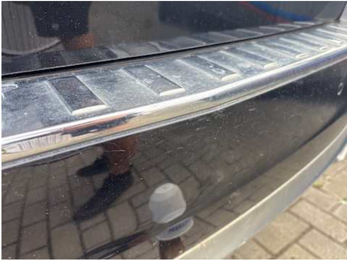
Stoßstange hinten (Kratzer, Verformung)
