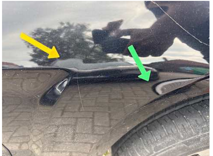
Kotflügel vorne rechts (Kratzer)
