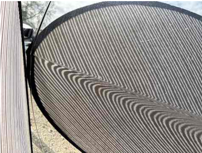
Türe hinten links (Delle)
