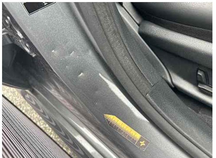
Schweller rechts (Kratzer, Delle)
