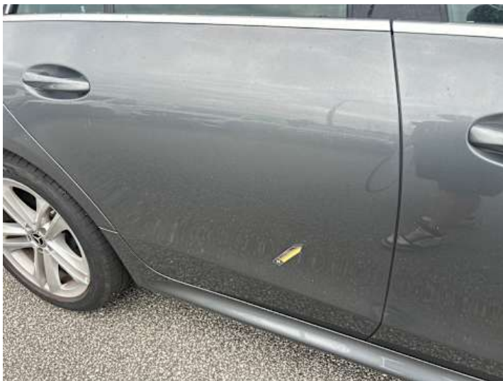
Türe hinten rechts (Delle, Kratzer)
