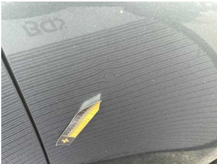
Kotflügel vorne rechts (Kratzer, Delle)
