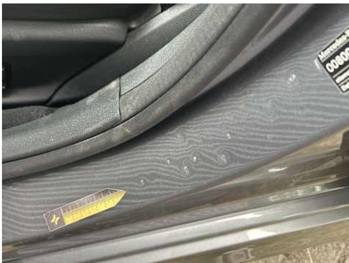
Schweller links (Delle, Kratzer)
