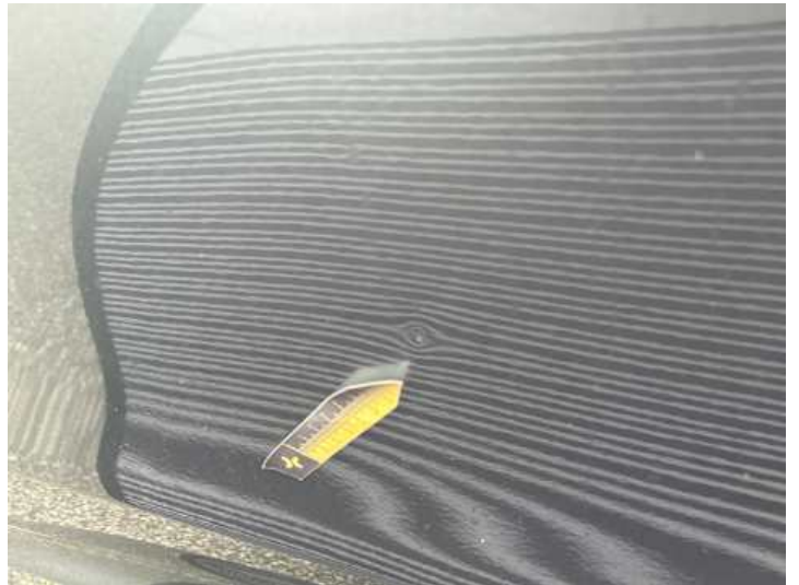
Türe hinten rechts (Delle, Kratzer)
