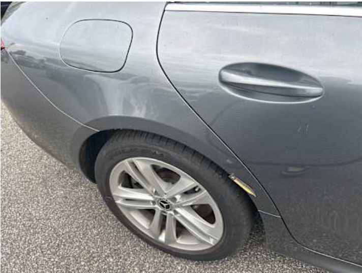
Seitenteil hinten rechts (Delle, Kratzer)
