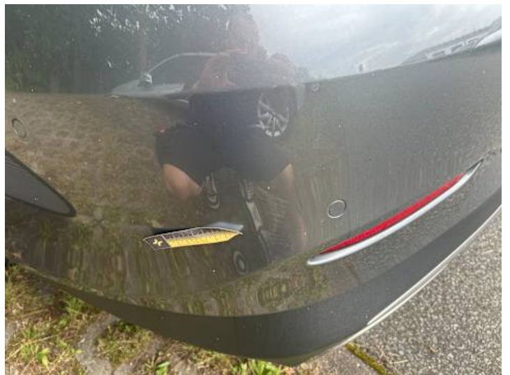
Stoßstange hinten (Kratzer)
