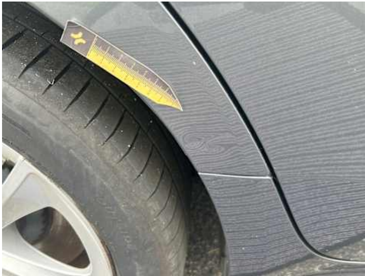
Seitenteil hinten rechts (Delle, Kratzer)
