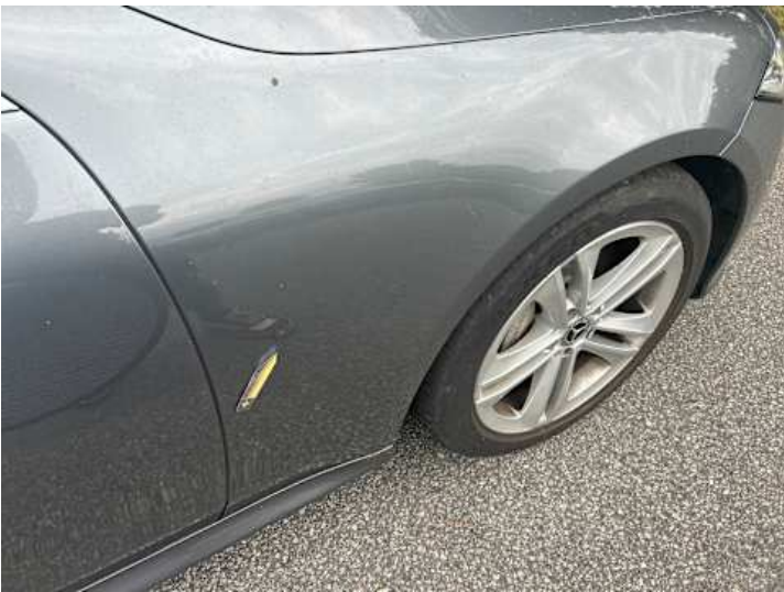
Kotflügel vorne rechts (Kratzer, Delle)
