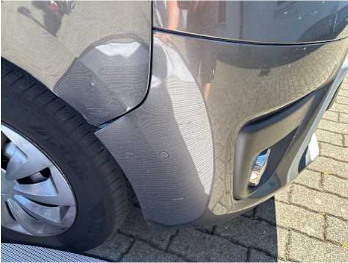
Stoßstange vorne (Kratzer, Verformung, Spaltmaße ungenau)
