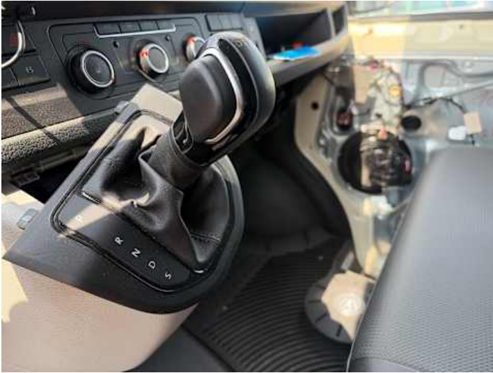
Innenraum (Anderer Schaden): Verkleidungen abgebaut und die Blende der Schaltung
