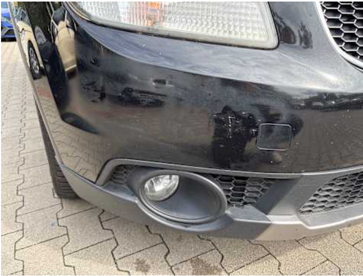
Stoßstange vorne (Kratzer, Verformung, Lackschaden)
