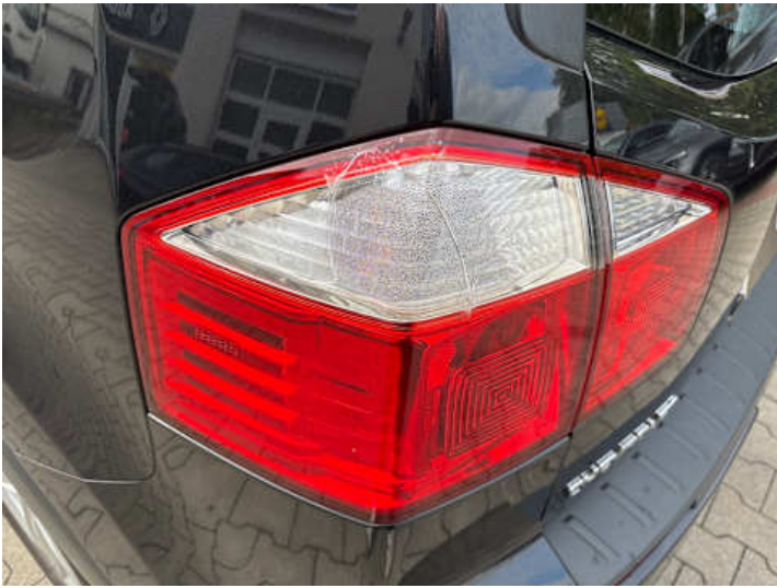
Rücklicht (links) (Riss/Bruch)
