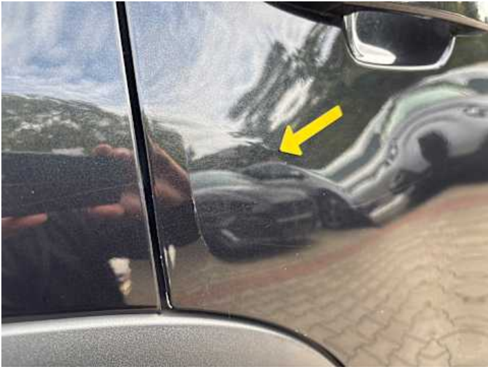
Türe hinten rechts (Kratzer, Delle)
