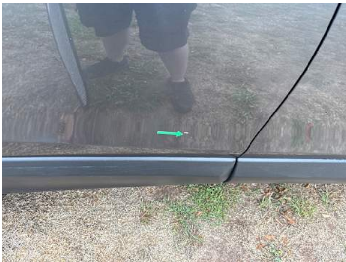
Türe hinten rechts (Lackschaden)
