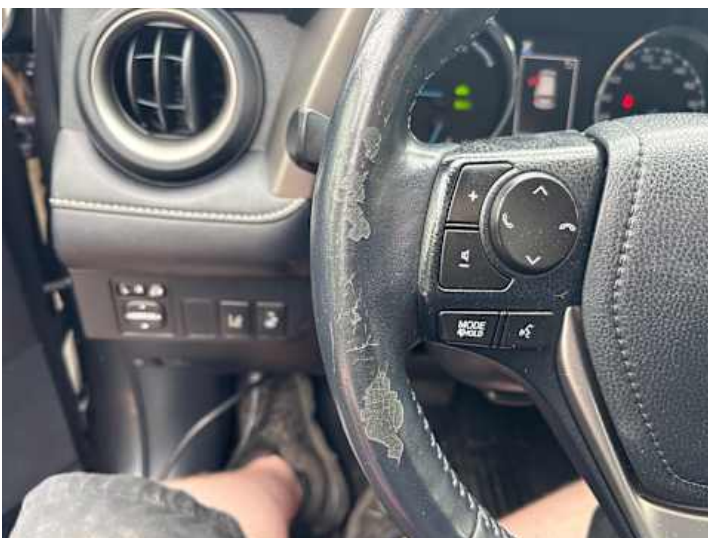
Innenraum (Verschmutzung, Verschleiß)
