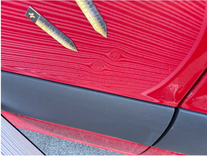
Türe hinten rechts (Delle)
