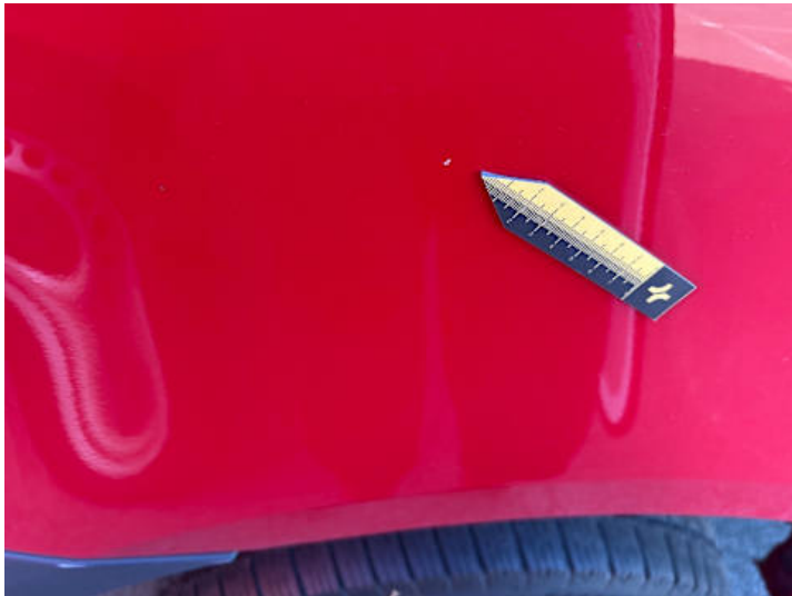
Seitenteil hinten rechts (Steinschlag)
