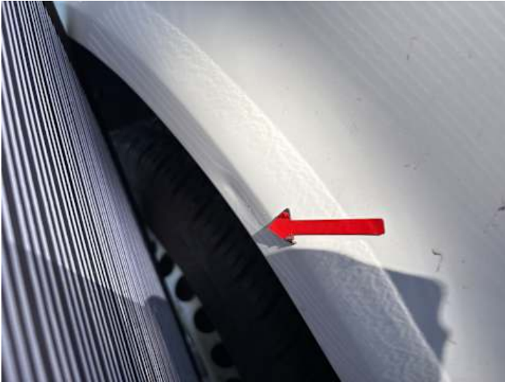
Kotflügel vorne rechts (Lackschaden, Verformung)
