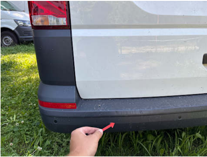
Stoßstange hinten (Verformung, Kratzer)
