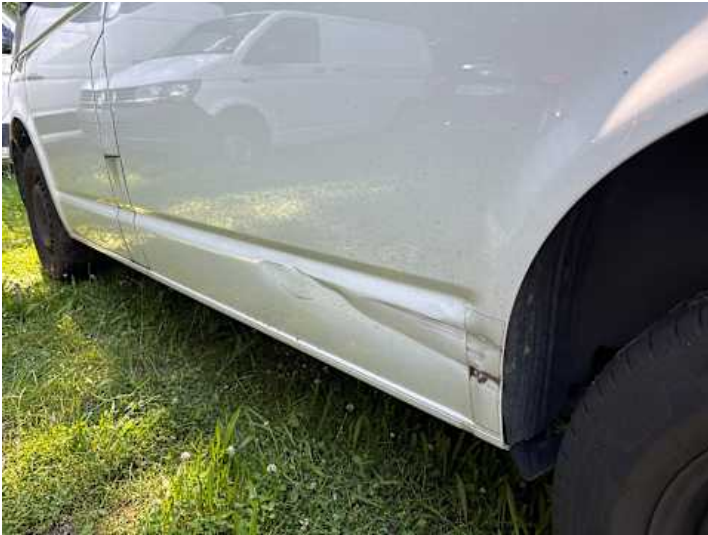
Seitenteil hinten links (Kratzer, Lackschaden, Verformung)
