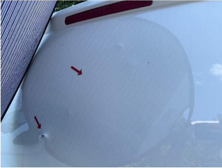
Heckklappe (Delle, Verformung)
