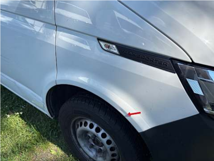
Kotflügel vorne rechts (Lackschaden, Verformung)
