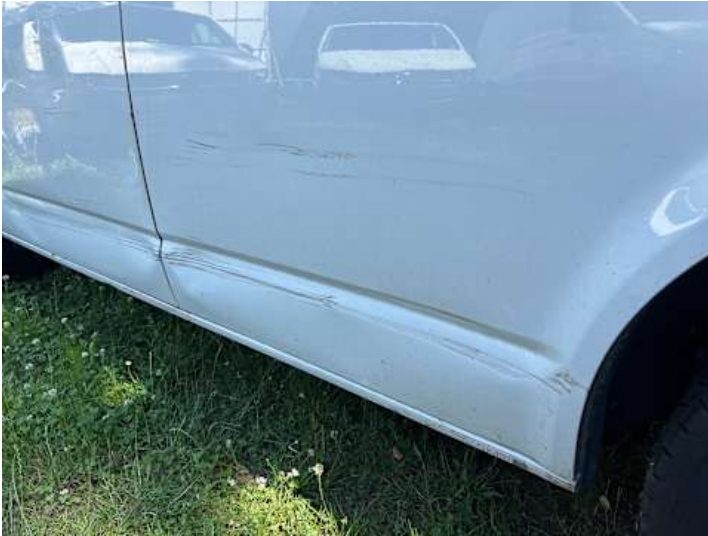
Beifahrertür (Kratzer, Lackschaden, Verformung)
