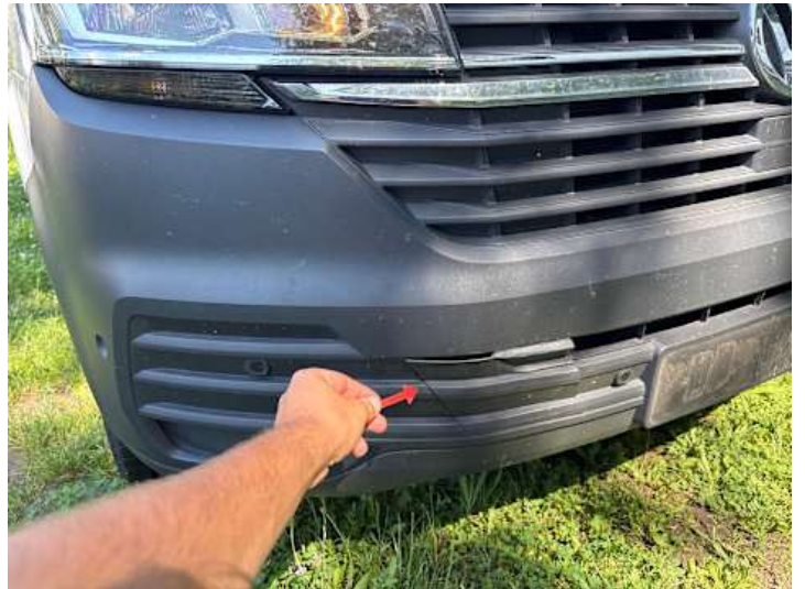
Stoßstange vorne (Kratzer, Verformung)
