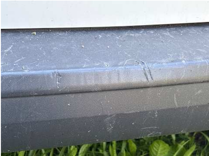
Stoßstange hinten (Verformung, Kratzer)
