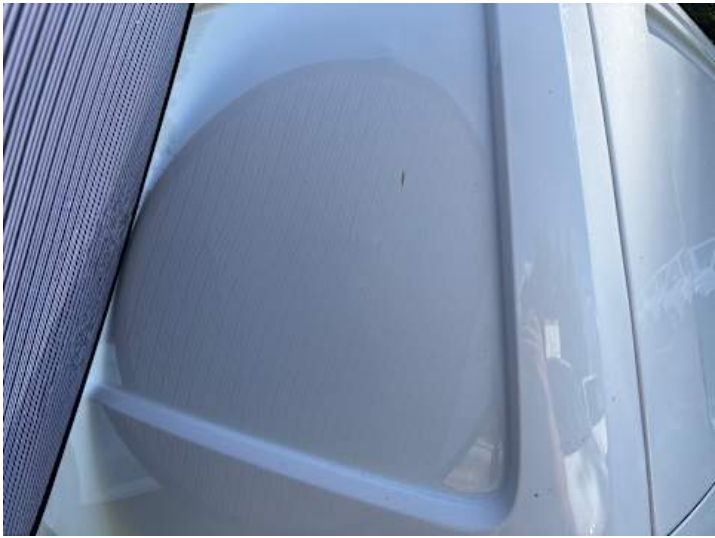
Heckklappe (Delle, Verformung)
