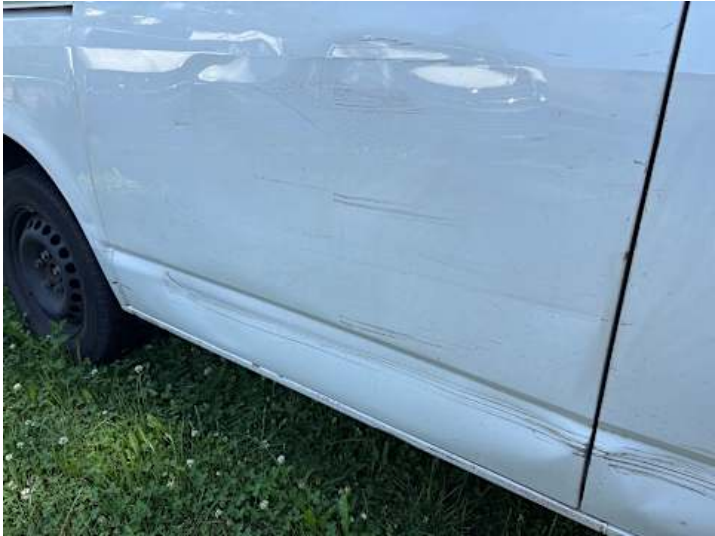
Türe hinten rechts (Kratzer, Lackschaden, Verformung)
