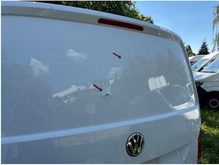
Heckklappe (Delle, Verformung)
