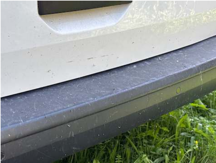
Stoßstange hinten (Verformung, Kratzer)
