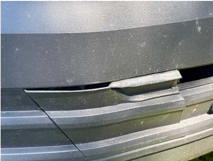
Stoßstange vorne (Kratzer, Verformung)
