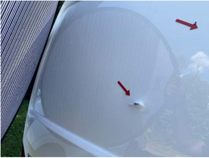
Heckklappe (Delle, Verformung)
