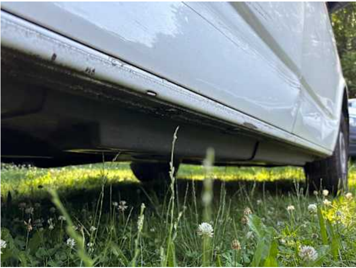
Schweller rechts (Kratzer, Lackschaden, Verformung)
