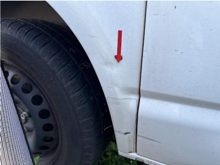
Seitenteil hinten rechts (Kratzer, Lackschaden, Verformung)
