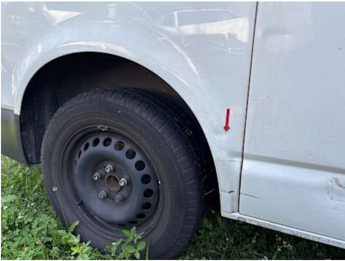
Seitenteil hinten rechts (Kratzer, Lackschaden, Verformung)
