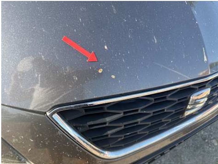
Motorhaube (Lackschaden, Rost)
