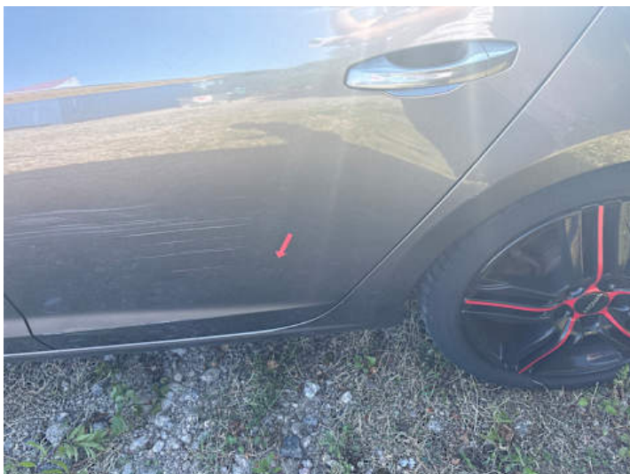
Türe hinten links (Delle)
