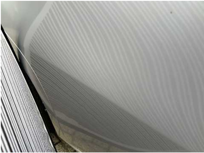
Türe hinten rechts (Kratzer, Delle)
