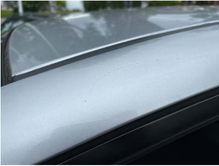
Dach (Delle, Kratzer)
