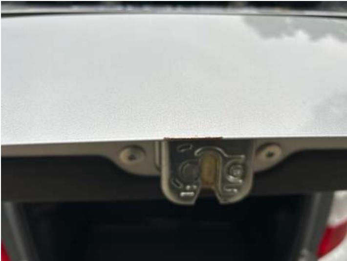
Heckklappe (Rost, Lackschaden, Delle)
