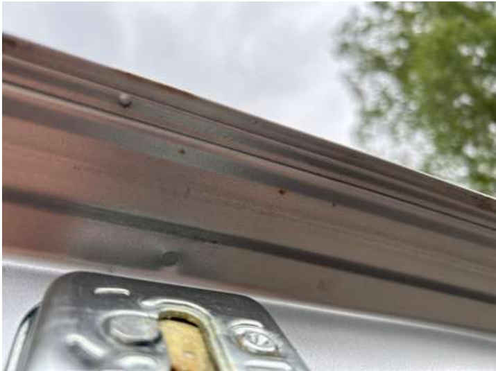
Heckklappe (Rost, Lackschaden, Delle)
