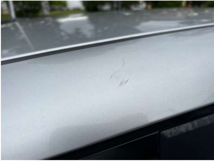
Dach (Delle, Kratzer)
