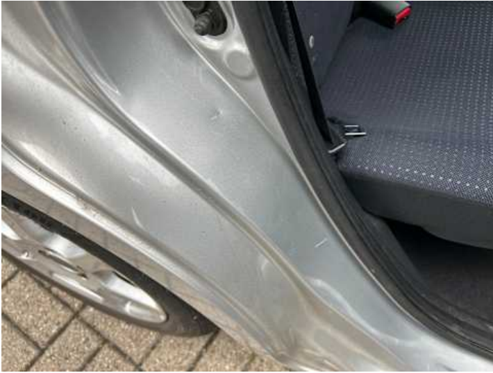
Türe hinten rechts (Kratzer, Delle)
