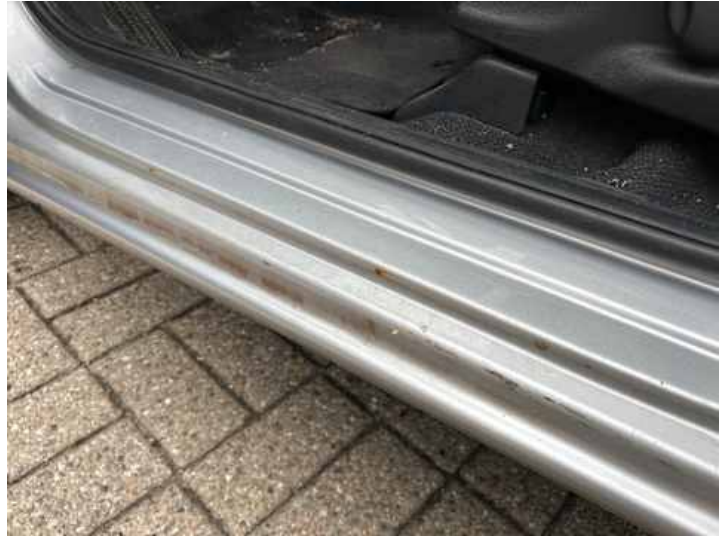
Schweller links (Rost)
