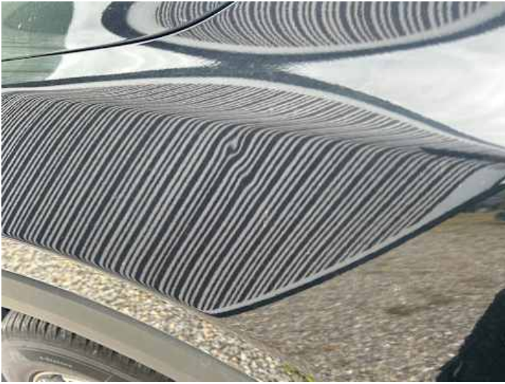
Kotflügel vorne links (Verformung)
