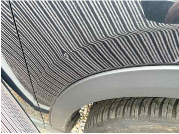
Kotflügel vorne rechts (Verformung)
