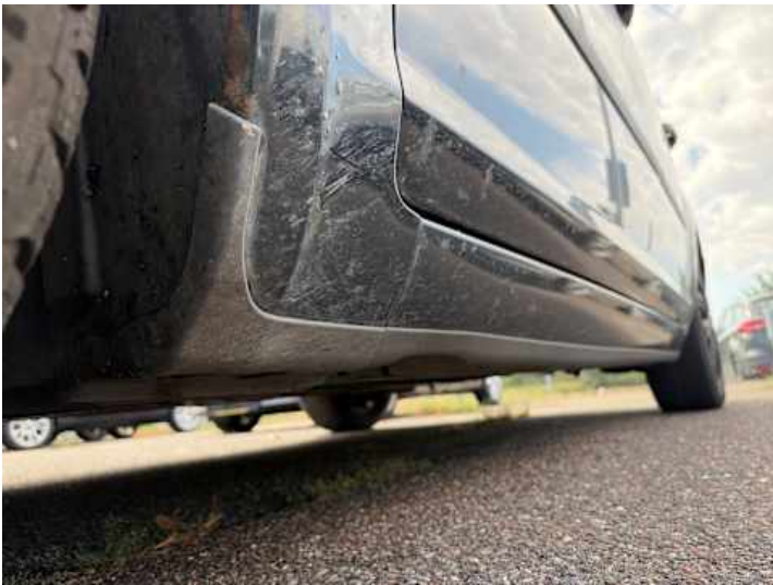
Schweller links (Rost)
