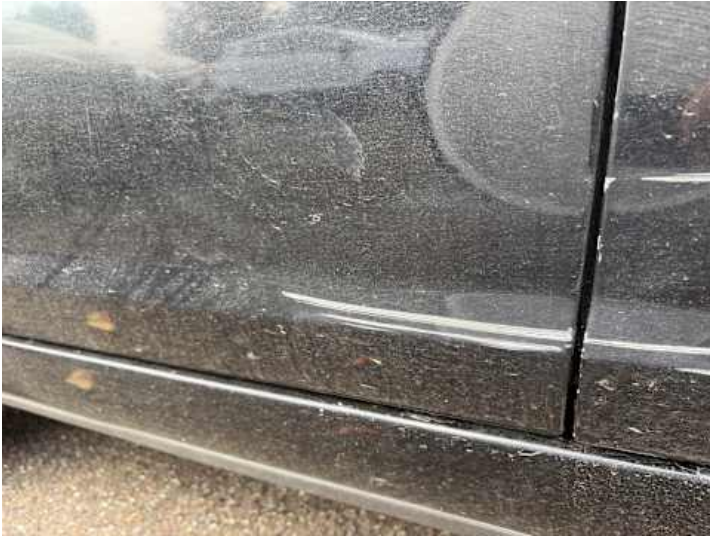
Türe hinten rechts (Kratzer, Lackschaden, Delle)
