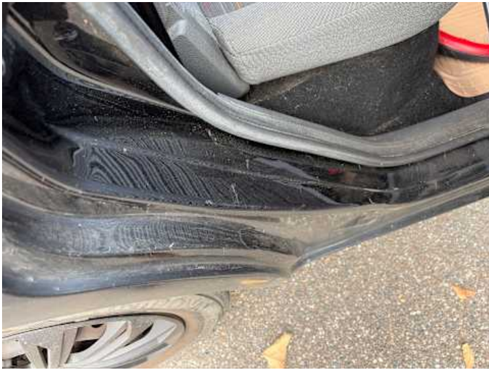
Türe hinten rechts (Kratzer, Lackschaden, Delle)
