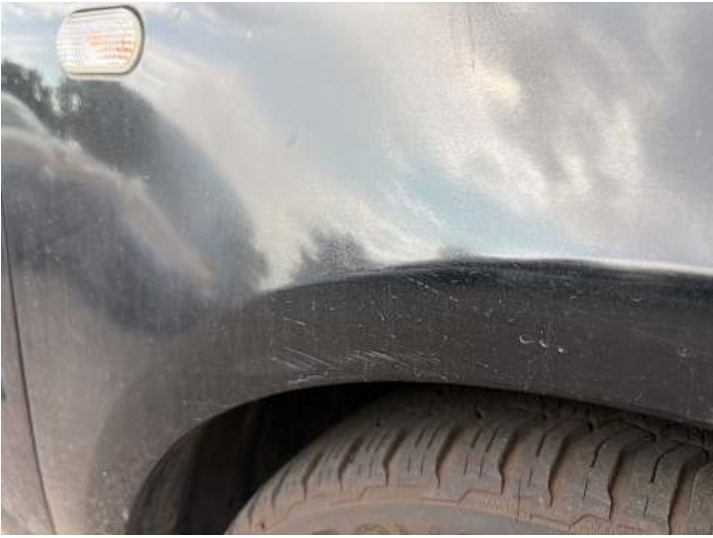
Kotflügel vorne rechts (Kratzer, Lackschaden)
