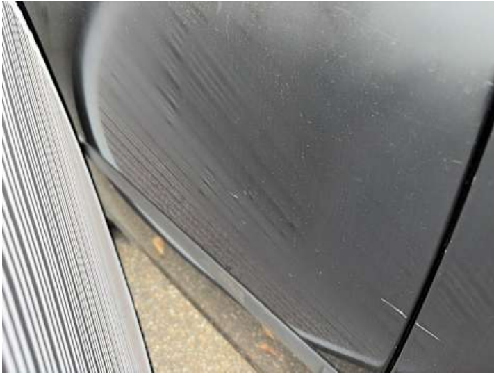
Türe hinten rechts (Kratzer, Lackschaden, Delle)
