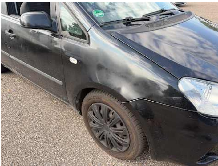
Kotflügel vorne rechts (Kratzer, Lackschaden)
