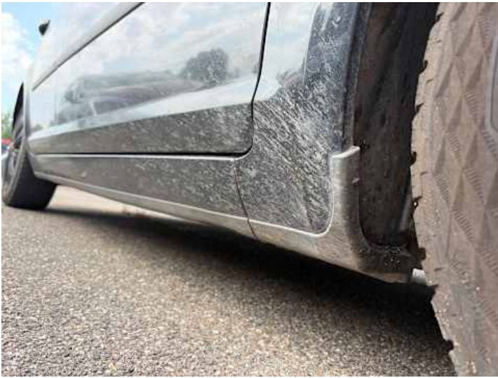
Schweller rechts (Rost)
