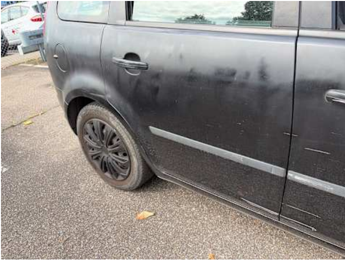
Türe hinten rechts (Kratzer, Lackschaden, Delle)
