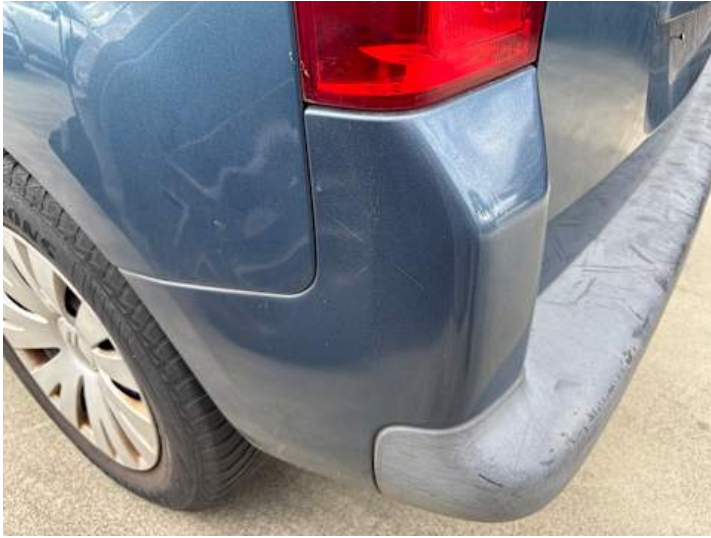
Stoßstange hinten (Kratzer, Riss/Bruch)
