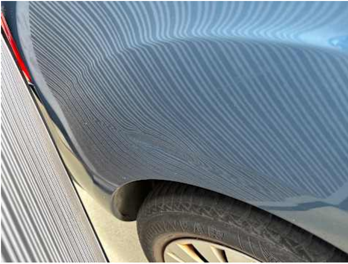
Seitenteil hinten rechts (Verformung, Kratzer)
