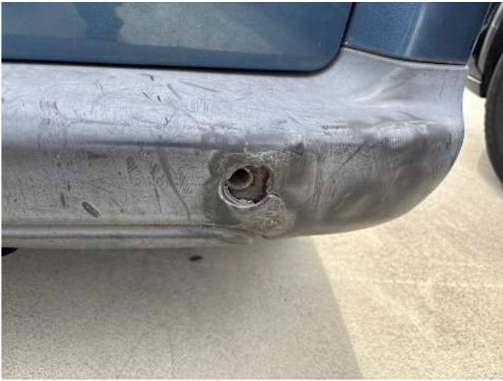
Stoßstange hinten (Kratzer, Riss/Bruch)
