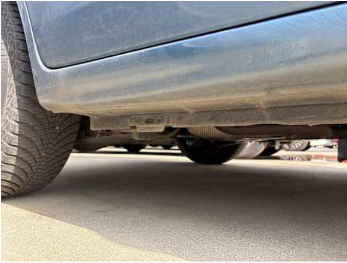
Schweller rechts (Verformung)
