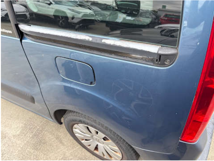
Seitenteil hinten links (Lackschaden)
