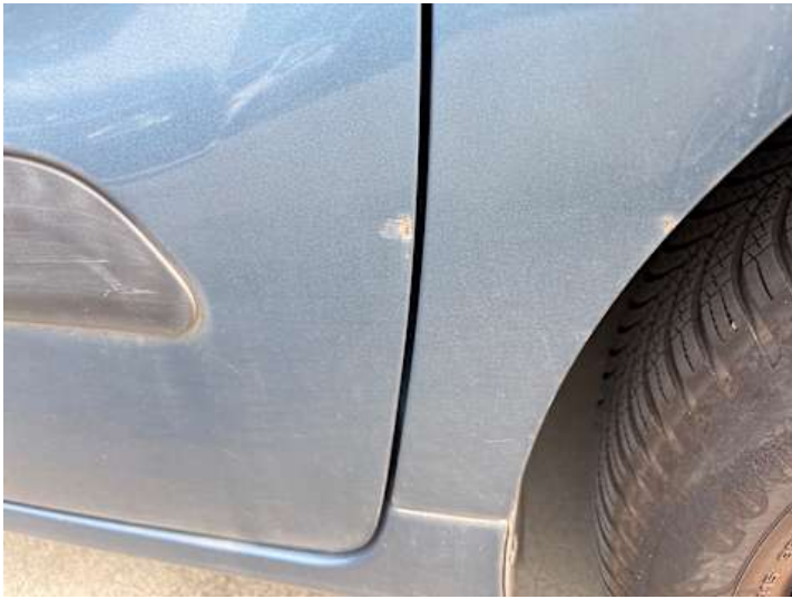
Beifahrertür (Kratzer, Rost)
