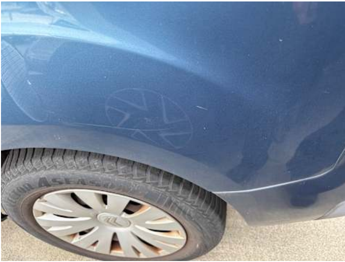
Seitenteil hinten links (Kratzer)
