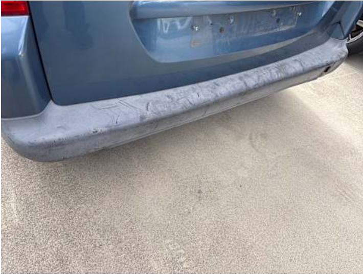
Stoßstange hinten (Kratzer, Riss/Bruch)
