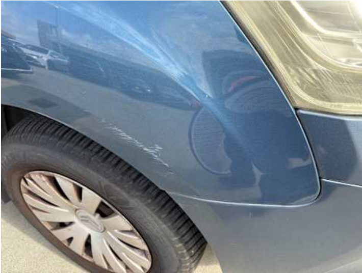
Kotflügel vorne rechts (Kratzer, Verformung)
