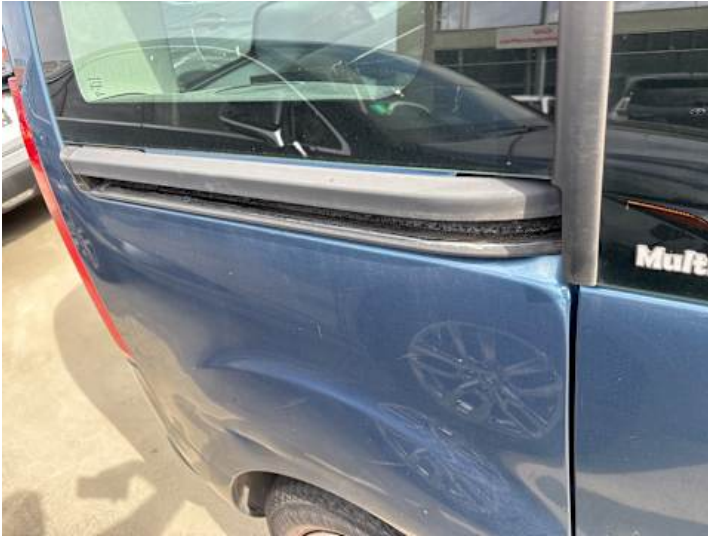
Seitenteil hinten rechts (Lackschaden)
