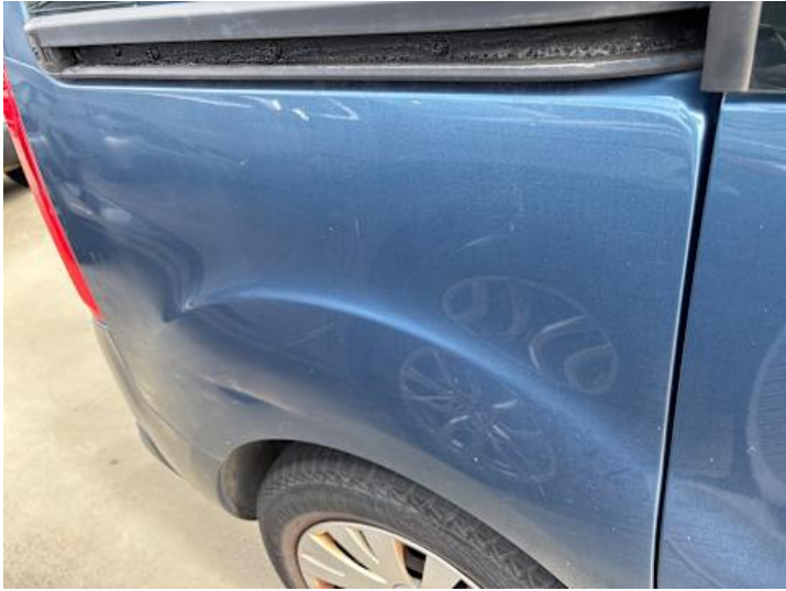
Seitenteil hinten rechts (Verformung, Kratzer)
