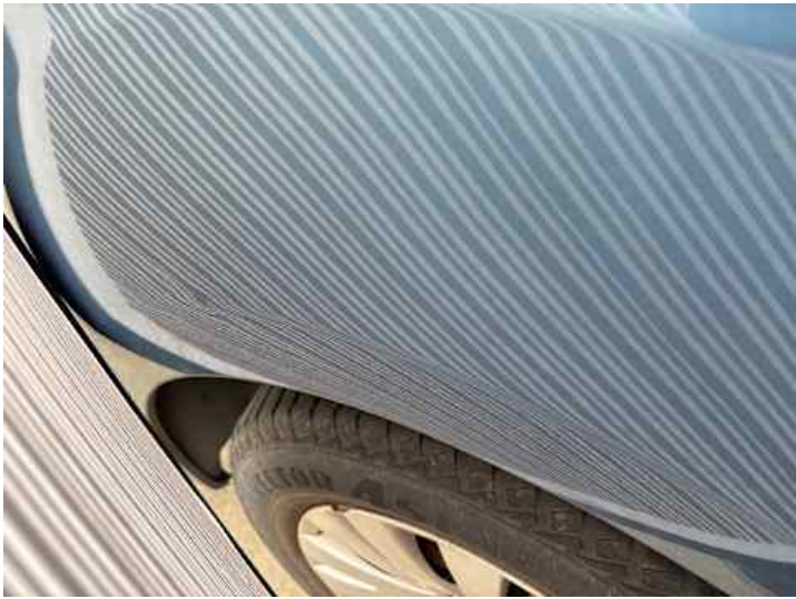
Seitenteil hinten links (Delle)
