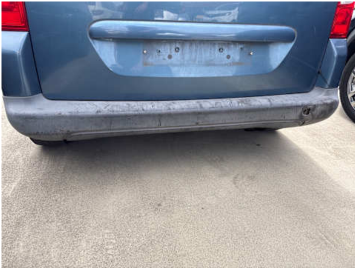
Stoßstange hinten (Kratzer, Riss/Bruch)
