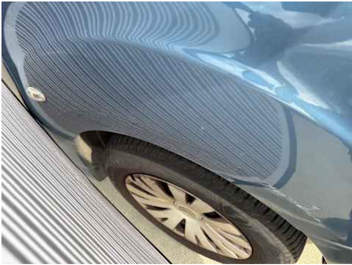
Kotflügel vorne rechts (Kratzer, Verformung)
