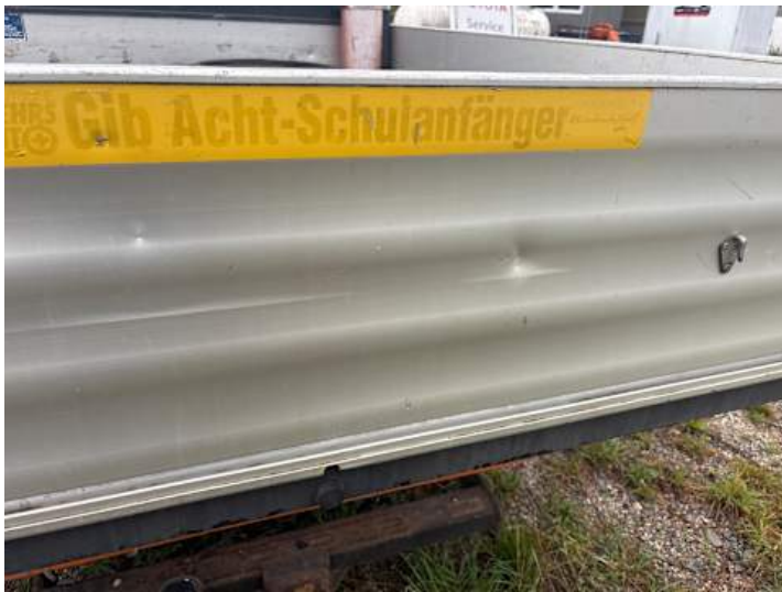
Heckklappe (Delle, Kratzer)
