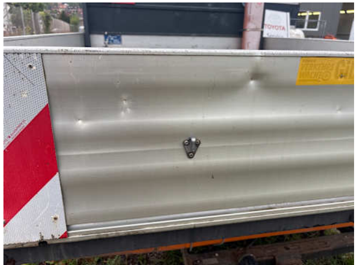
Heckklappe (Delle, Kratzer)
