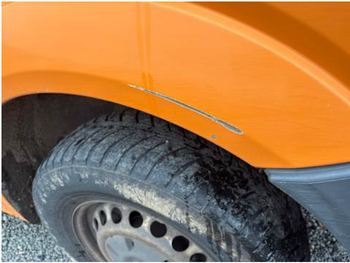
Kotflügel vorne rechts (Kratzer, Rost)
