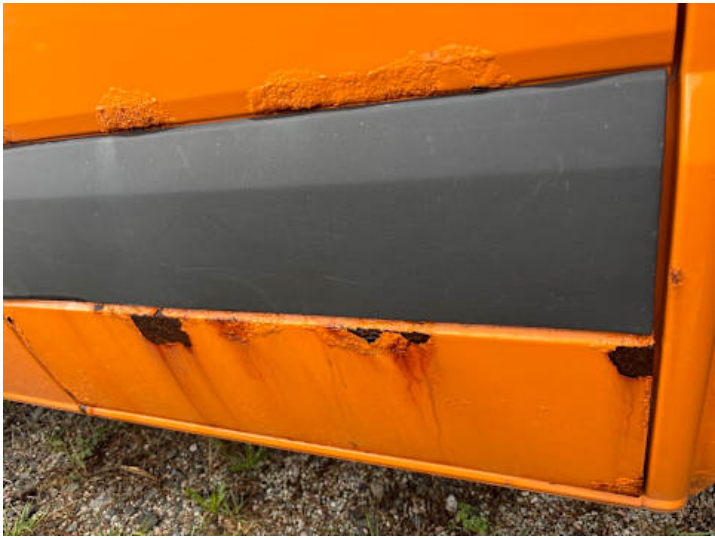
Türe hinten links (Rost)
