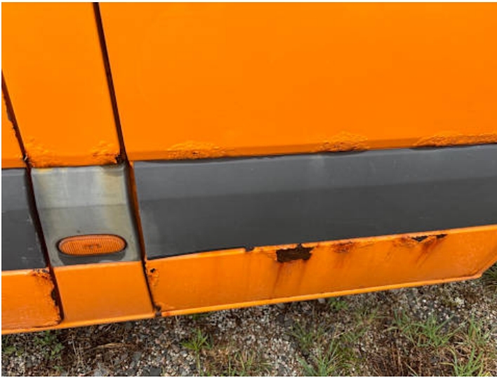
Türe hinten links (Rost)
