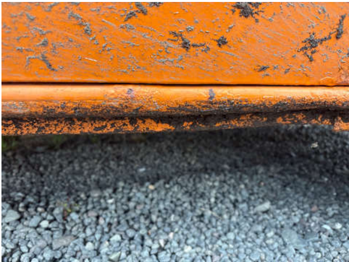
Schweller rechts (Rost)
