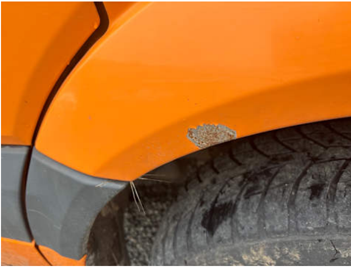
Kotflügel vorne rechts (Kratzer, Rost)
