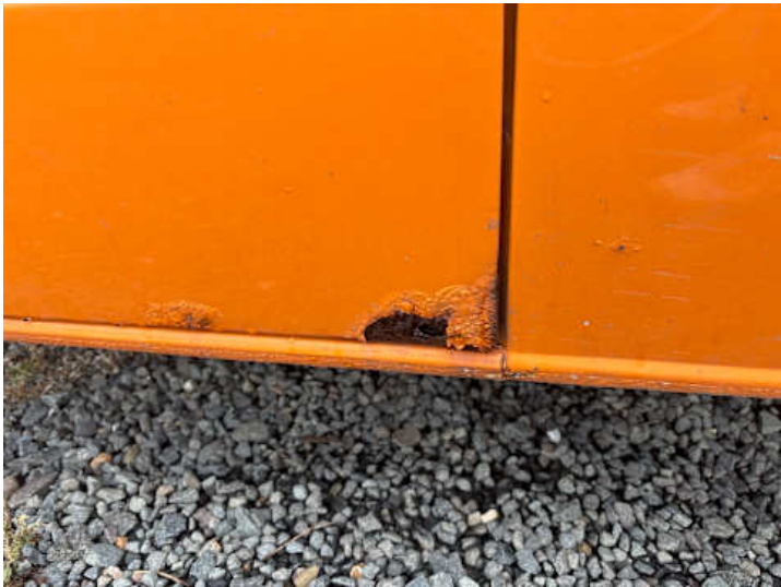
Türe hinten rechts (Rost)
