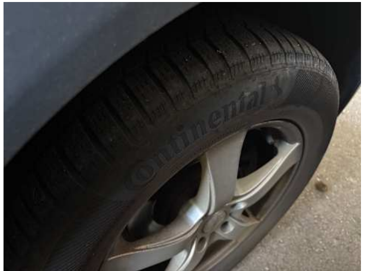
Rad (Ungleichmäßig abgefahren)
