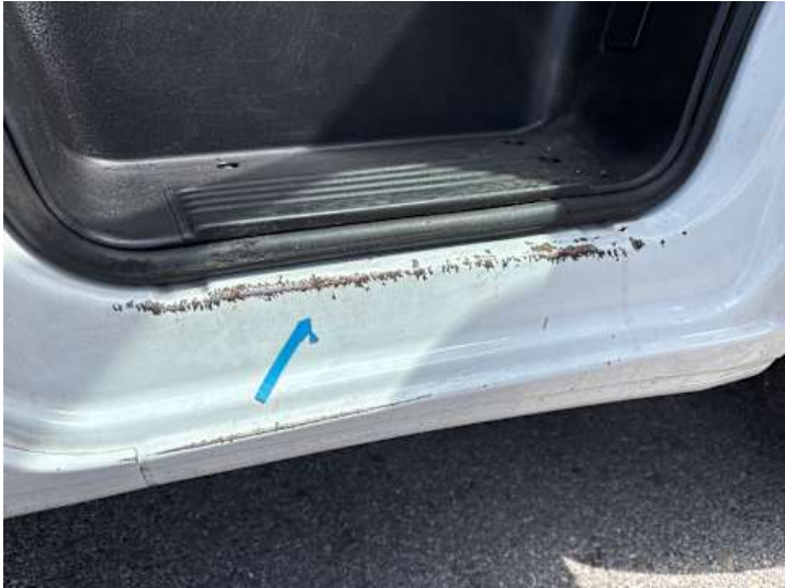
Schweller rechts (Lackschaden)
