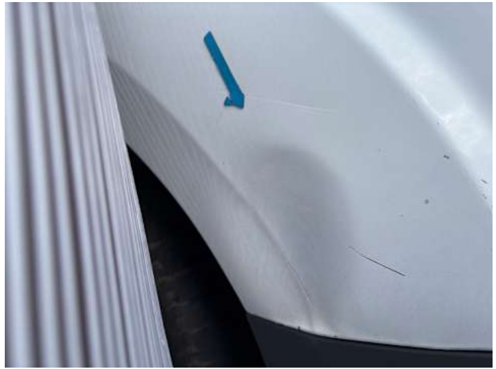
Kotflügel vorne rechts (Delle, Kratzer)
