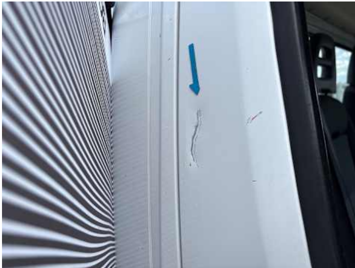
Beifahrertür (Delle, Kratzer)
