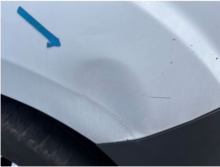
Kotflügel vorne rechts (Delle, Kratzer)
