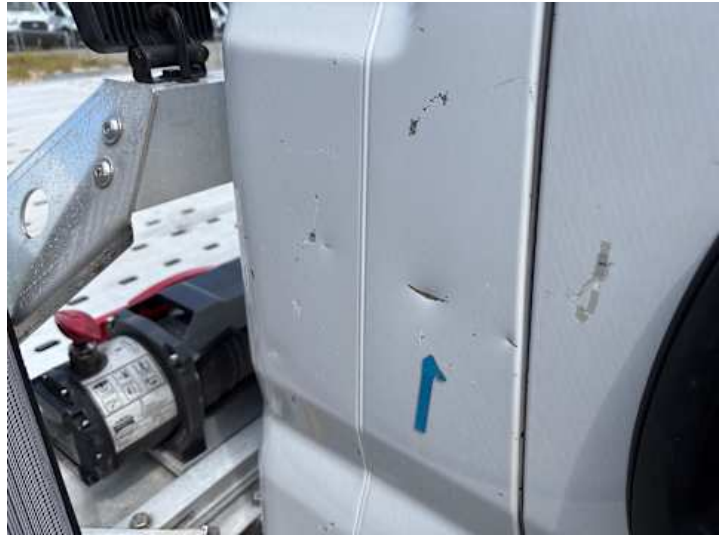
Seitenteil hinten rechts (Delle, Kratzer)
