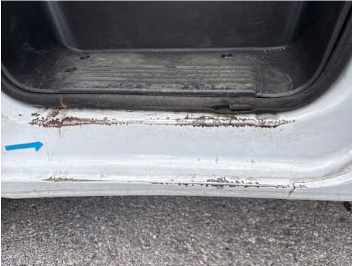
Schweller links (Lackschaden)
