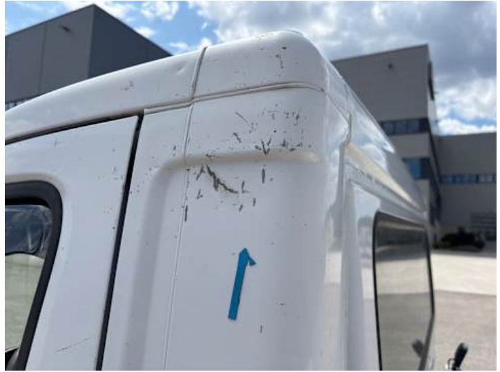
Seitenteil hinten links (Delle, Kratzer)
