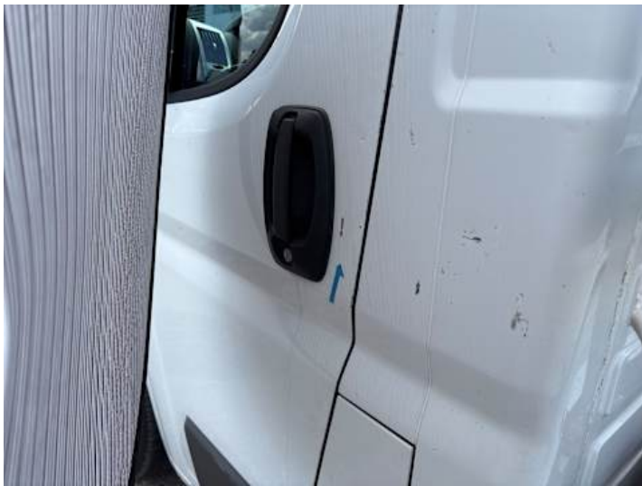
Fahrrertür (Delle, Kratzer)
