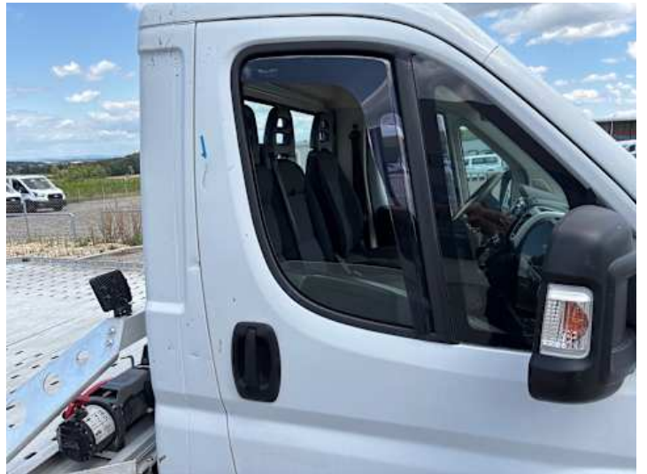
Beifahrertür (Delle, Kratzer)
