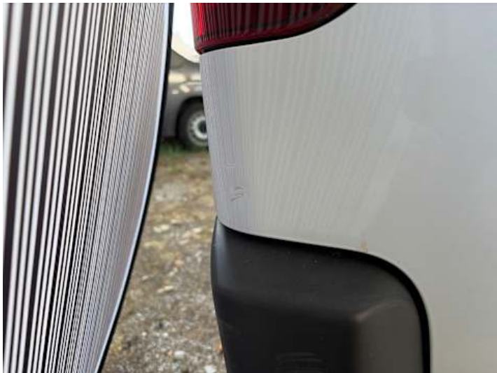
Heckklappe (Lackschaden, Kratzer, Delle)
