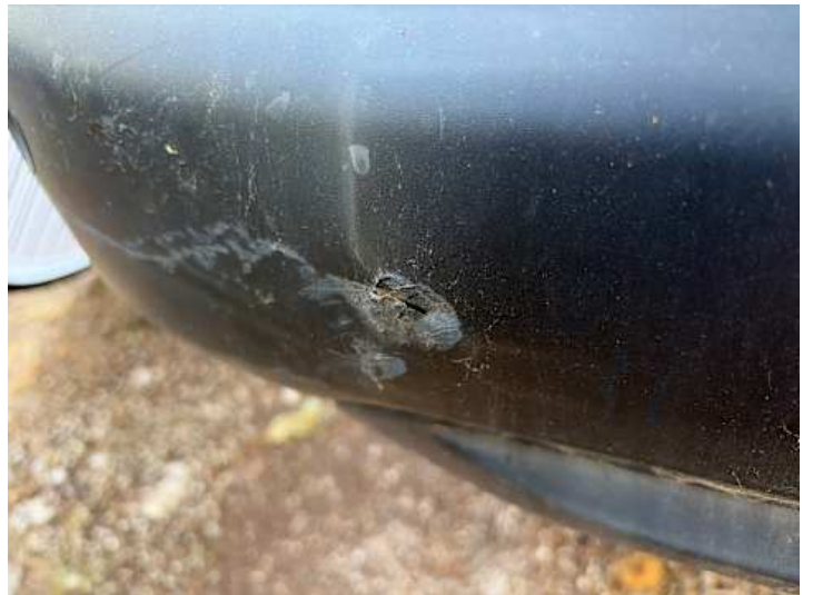
Stoßstange hinten (Riss/Bruch)
