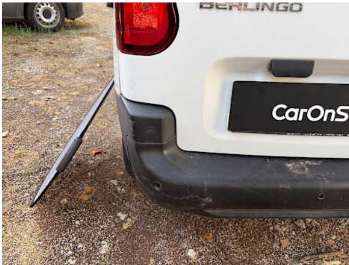
Stoßstange hinten (Riss/Bruch)
