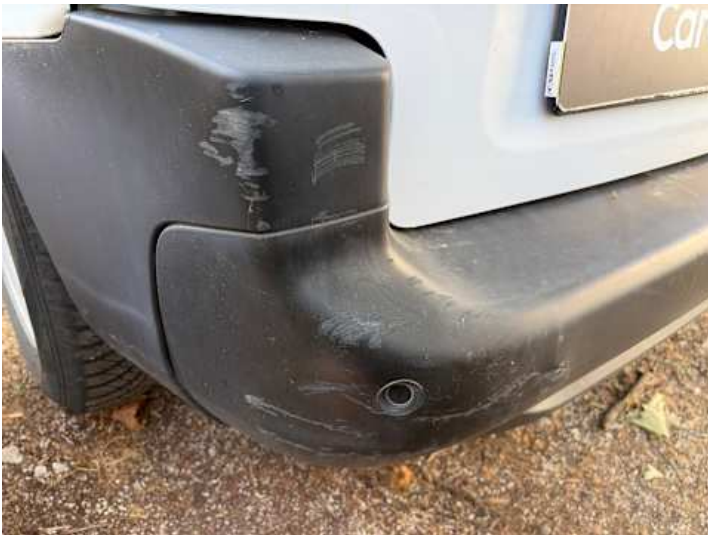
Stoßstange hinten (Riss/Bruch)
