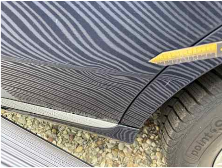
Türe hinten links (Delle)
