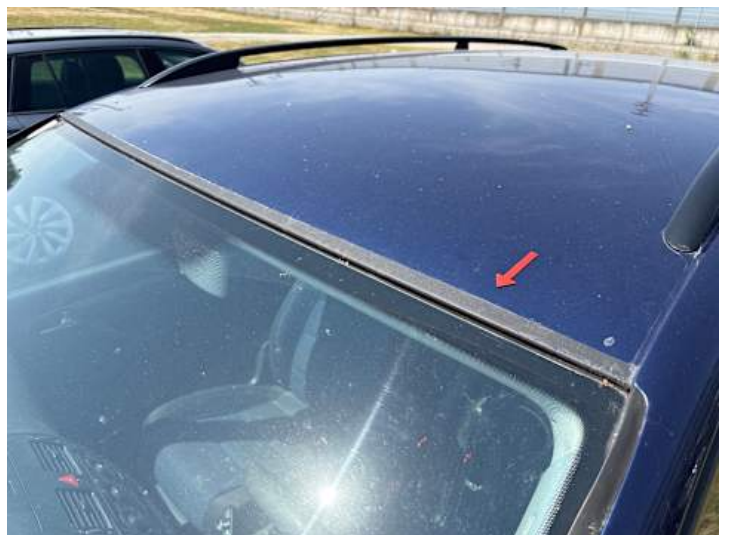
Dach (Kratzer, Lackschaden)
