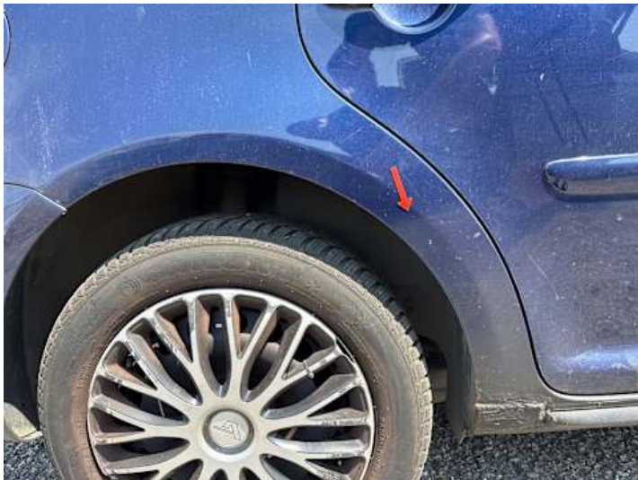
Seitenteil hinten rechts (Rost, Unsachgemäß instand gesetzt)
