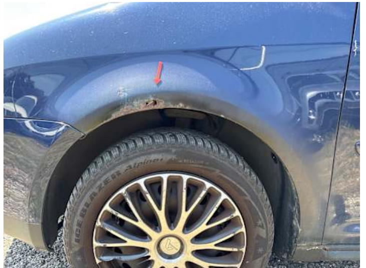
Kotflügel vorne links (Rost)
