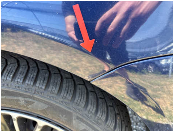
Seitenteil hinten links (Riss/Bruch, Unsachgemäß instand gesetzt)
