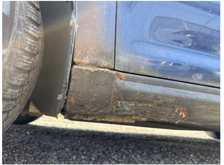
Schweller links (Rost)
