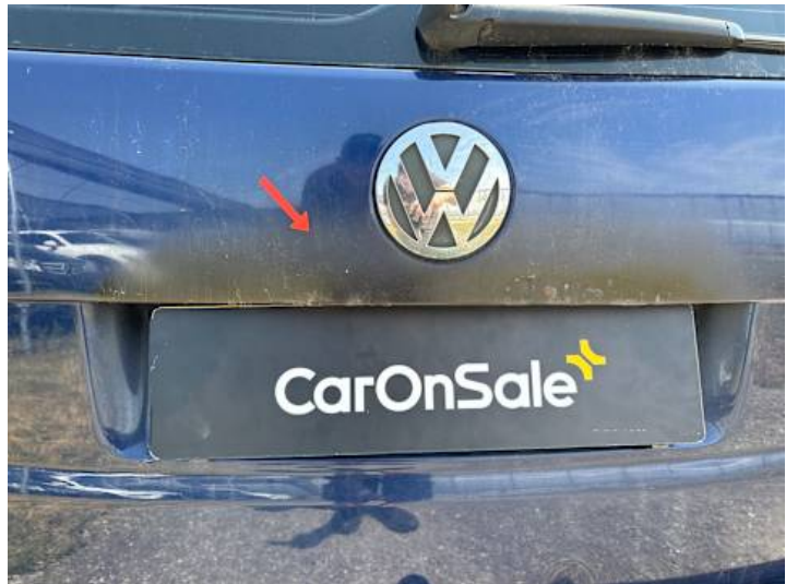
Heckklappe (Verformung, Rost, Unsachgemäß instand gesetzt)
