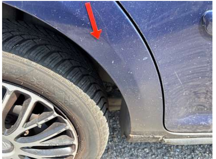
Seitenteil hinten rechts (Rost, Unsachgemäß instand gesetzt)
