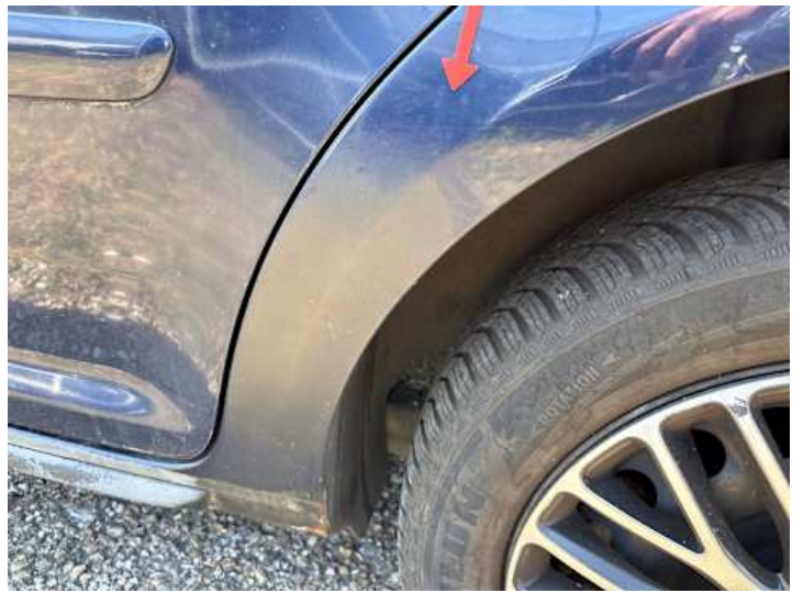
Seitenteil hinten links (Riss/Bruch, Unsachgemäß instand gesetzt)
