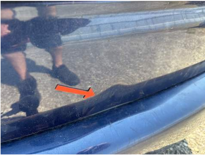
Heckklappe (Verformung, Rost, Unsachgemäß instand gesetzt)
