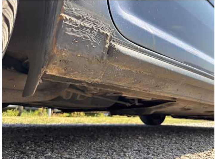
Schweller rechts (Rost)
