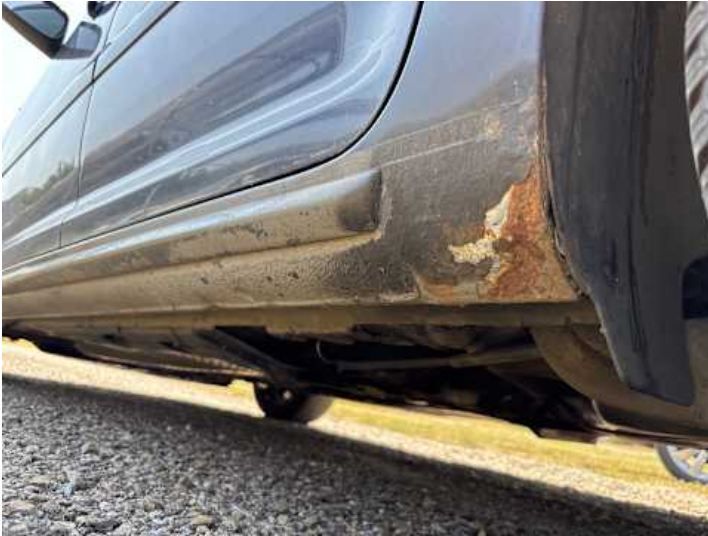
Schweller links (Rost)
