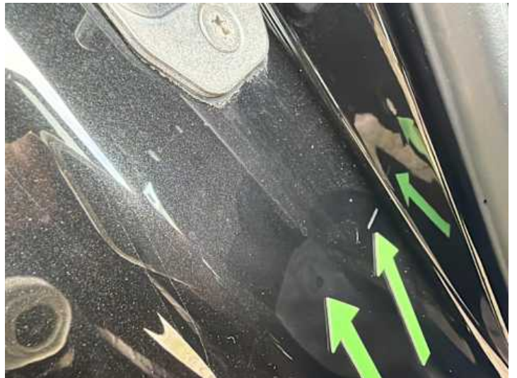
Schweller rechts (Delle)
