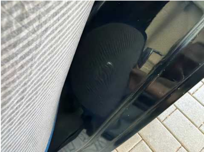
Türe hinten links (Kratzer, Delle)
