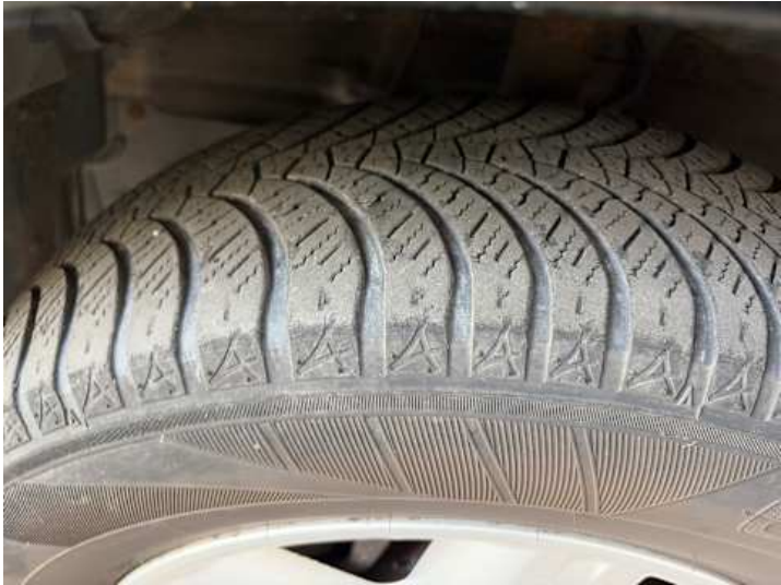
Rad (Ungleichmäßig abgefahren)
