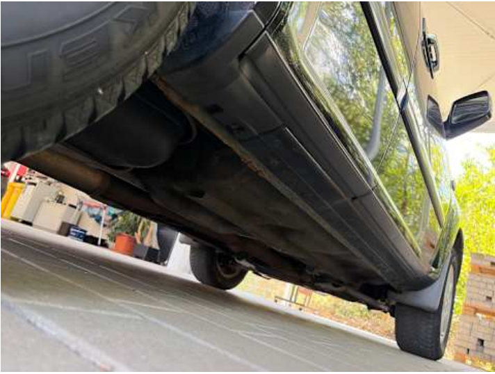
Schweller rechts (Rost)
