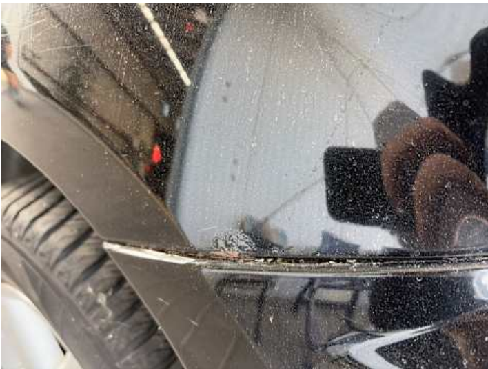
Seitenteil hinten links (Rost, Kratzer)
