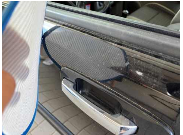
Fahrtür (Kratzer, Delle)
