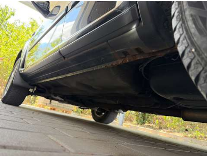
Schweller links (Rost)
