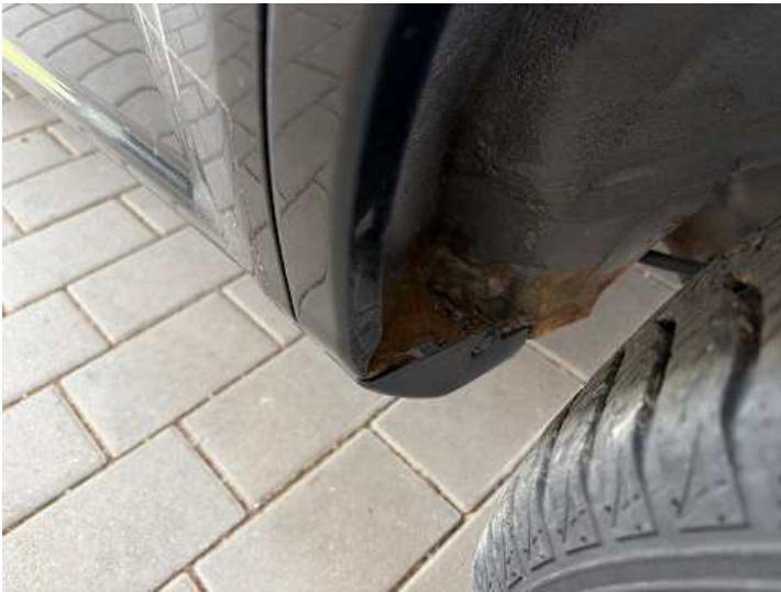
Schweller links (Rost)
