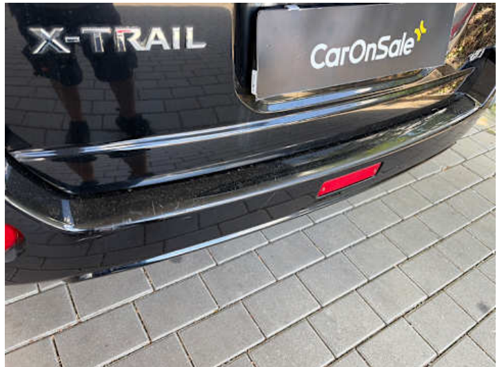
Stoßstange hinten (Kratzer)
