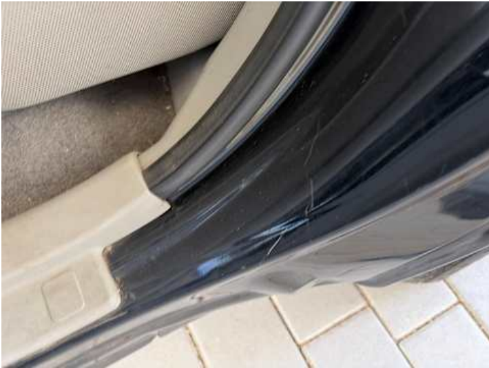
Türe hinten links (Kratzer, Delle)
