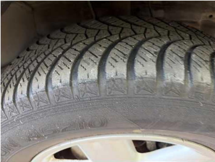
Rad (Ungleichmäßig abgefahren)
