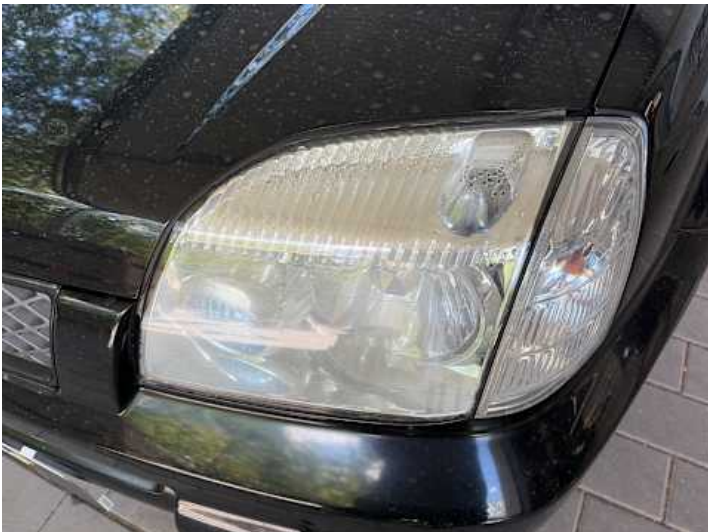
Scheinwerfer (links) (Undicht)
