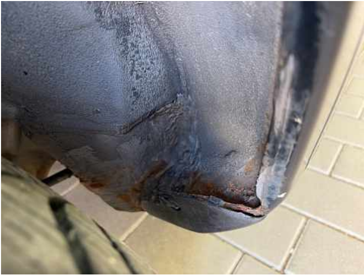
Schweller rechts (Rost)
