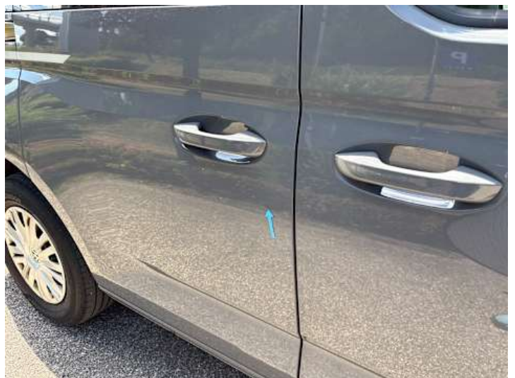
Türe hinten rechts (Delle)
