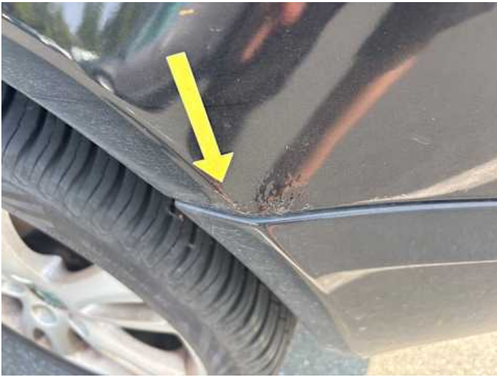
Seitenteil hinten links (Lackschaden, Rost)
