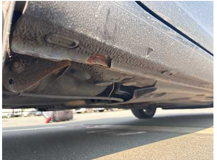
Schweller rechts (Verformung, Rost)
