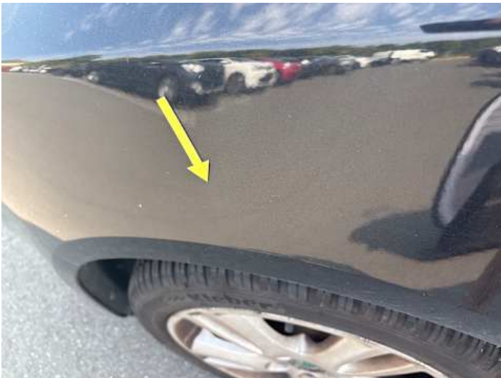
Kotflügel vorne links (Kratzer)
