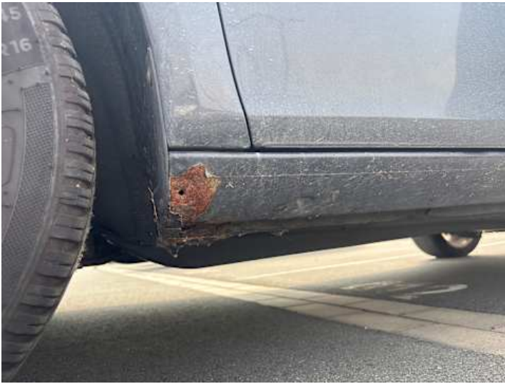
Schweller links (Rost, Verformung)
