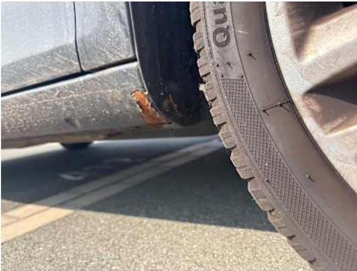
Schweller rechts (Verformung, Rost)
