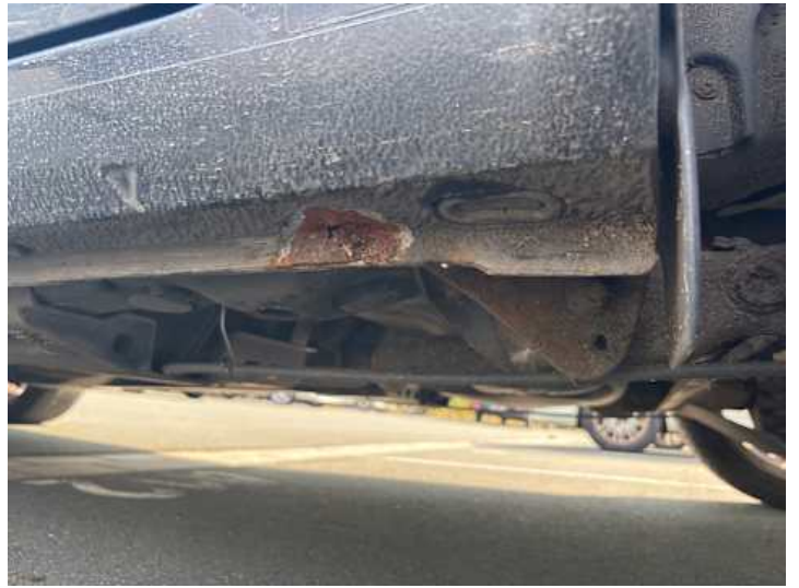
Schweller links (Rost, Verformung)
