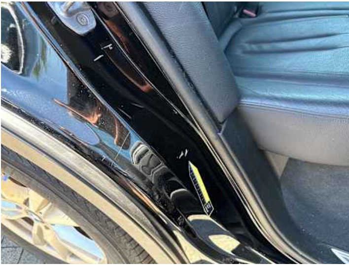
Türe hinten rechts (Delle, Kratzer)
