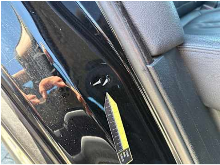
Türe hinten rechts (Delle, Kratzer)
