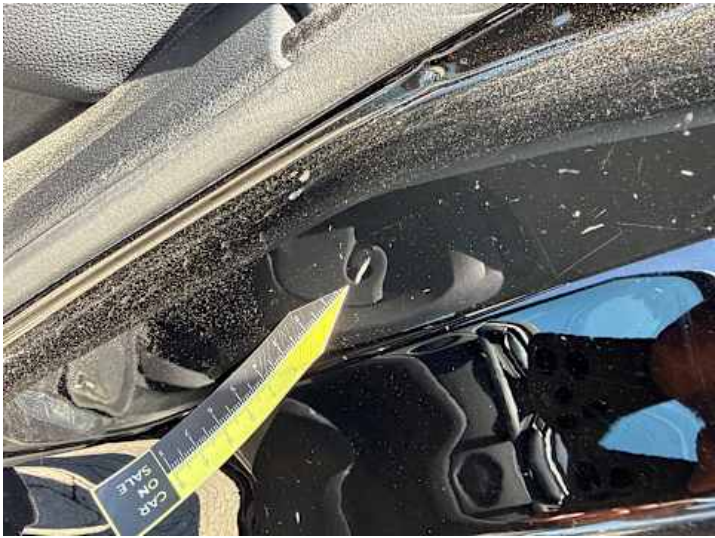
Türe hinten links (Kratzer, Delle)
