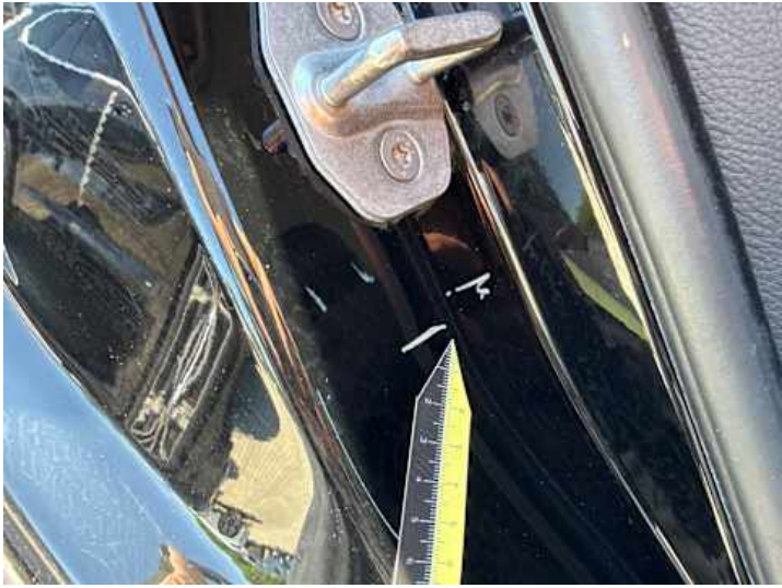
Türe hinten rechts (Delle, Kratzer)
