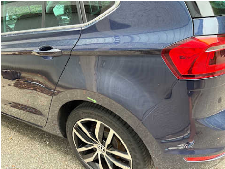
Seitenteil hinten links (Rost)
