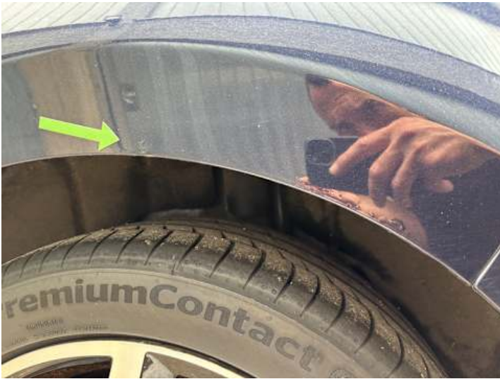
Seitenteil hinten links (Rost)
