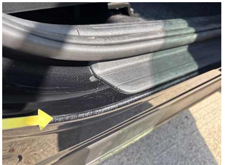
Schweller rechts (Kratzer)
