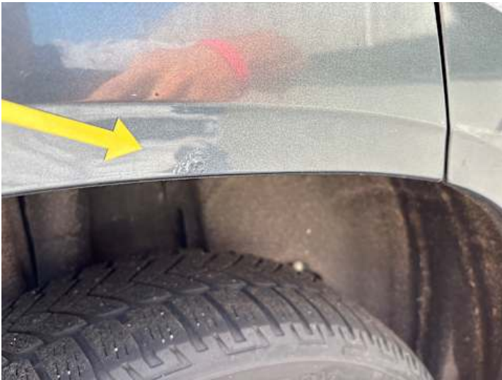
Seitenteil hinten rechts (Rost)
