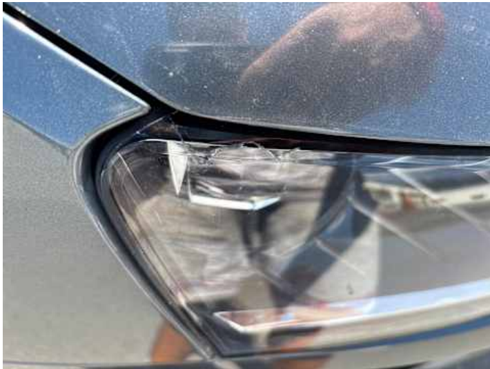
Scheinwerfer (rechts) (Riss/Bruch)
