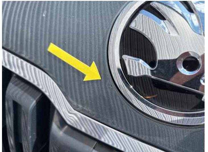
Motorhaube (Delle, Steinschlag)
