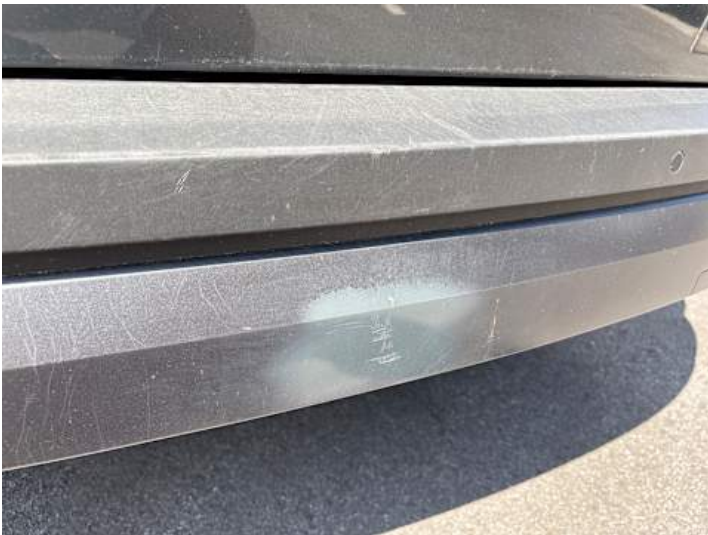
Stoßstange hinten (Lackschaden, Unsachgemäß instand gesetzt)
