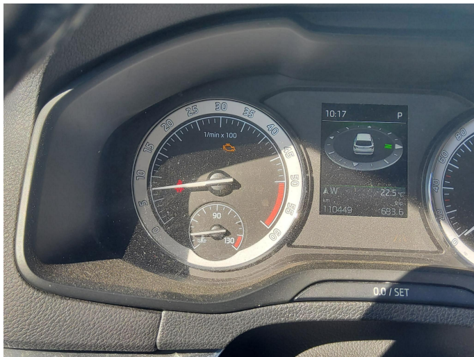
Bild 1: Technik, Motor, Motorkontrollleuchte leuchtet, prüfen und Befund festlegen, Schadenerweiterung möglich
