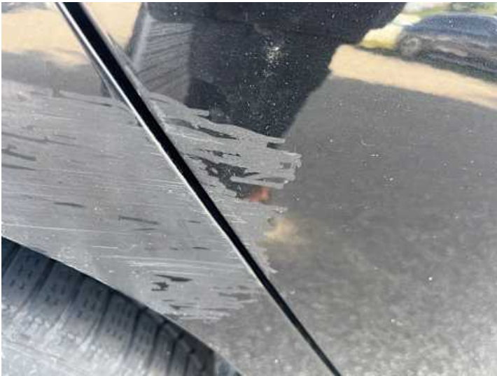
Türe hinten rechts (Lackschaden, Unsachgemäß instand gesetzt)
