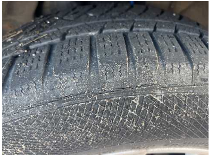
Rad (vehicle.damage-label.porous, Anderer Schaden): Rissig
