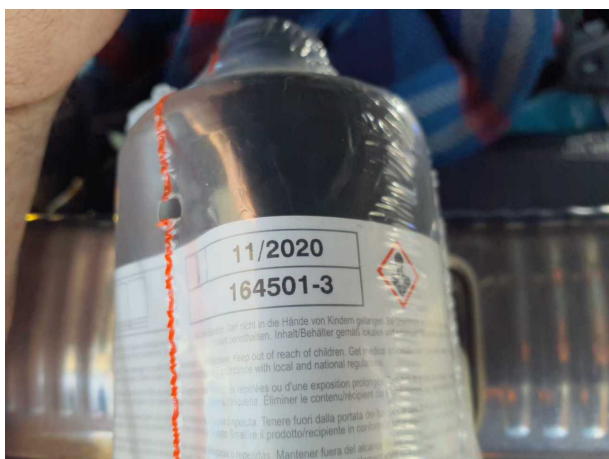
Beschädigung #1: Ausrüstung: Tirefit Füllmittel - abgelaufen - erneuern
