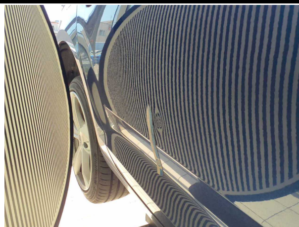
Beschädigung #4: Tür hinten rechts: Tür - Delle(n) - sanft instandsetzen
