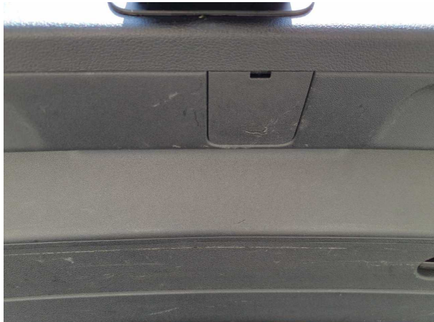
Beschädigung #2: Verkleidungen/Abdeckungen: Heckdeckel, Innenverkleidung - Kratzer - Wertminderung
