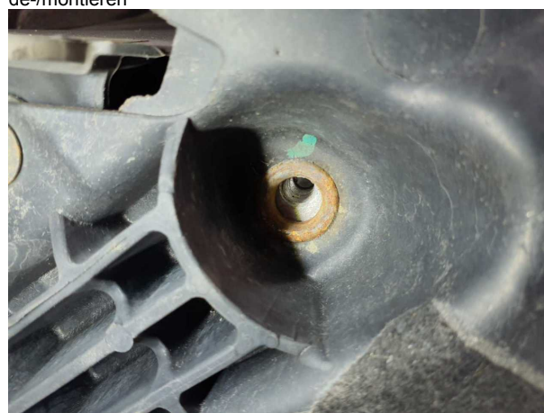
Beschädigung #5: Karosserie: Unterbodenverkleidung - lose - de-/montieren
