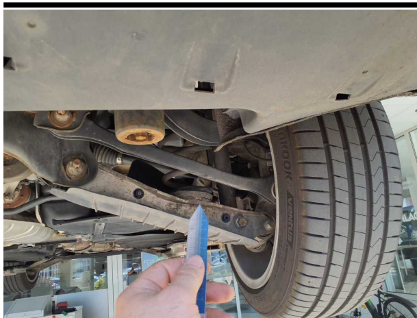
Beschädigung #8: Hinterachse: Feder rechts (Anschlagpuffer) - beschädigt - erneuern
