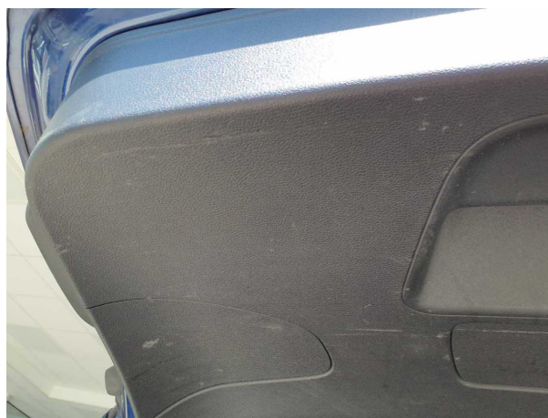
Beschädigung #2: Verkleidungen/Abdeckungen: Heckdeckel, Innenverkleidung - Kratzer - Wertminderung
