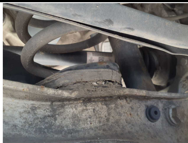
Beschädigung #8: Hinterachse: Feder rechts (Anschlagpuffer) - beschädigt - erneuern
