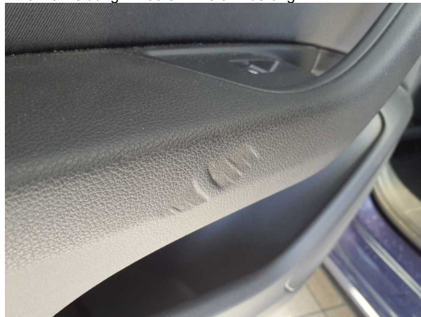
Beschädigung #3: Verkleidungen/Abdeckungen: Türverkleidung hinten links - Delle(n) - Wertminderung
