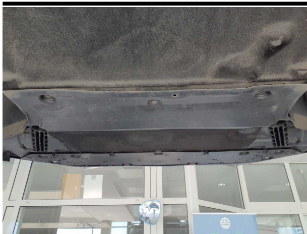
Beschädigung #5: Karosserie: Unterbodenverkleidung - lose - de-/montieren
