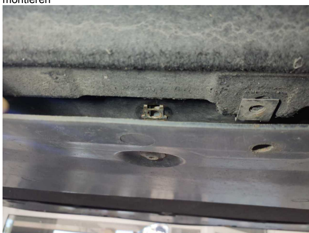
Beschädigung #5: Karosserie: Unterbodenverkleidung - lose - de-/montieren
