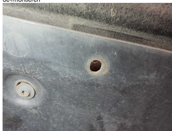
Beschädigung #5: Karosserie: Unterbodenverkleidung - lose - de-/montieren
