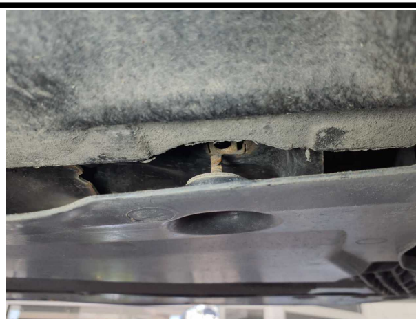
Beschädigung #5: Karosserie: Unterbodenverkleidung - lose - de-/montieren
