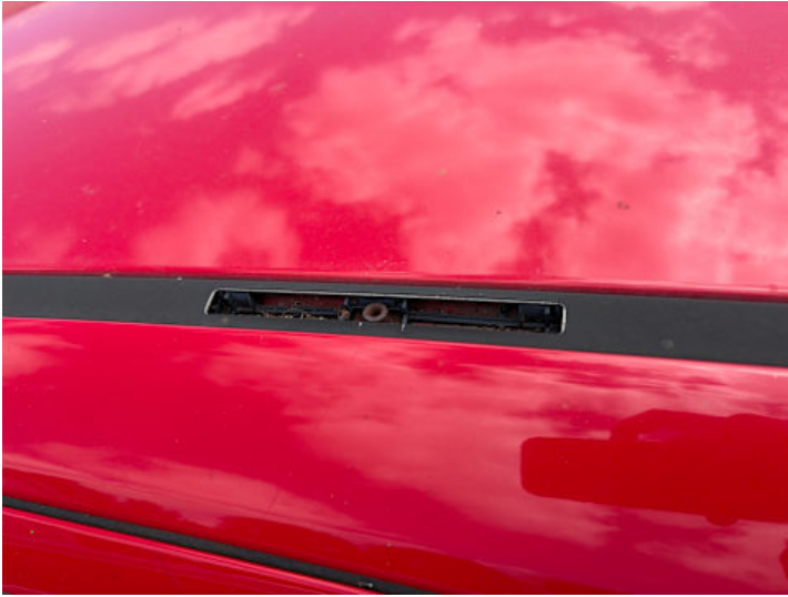
Dach (Anderer Schaden): Abdeckkappen linke Seite fehlen
