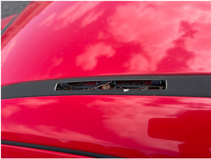
Dach (Anderer Schaden): Abdeckkappen linke Seite fehlen
