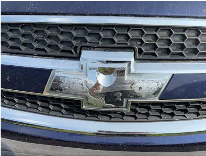
Stoßstange vorne (Anderer Schaden): Emblem fehlt
