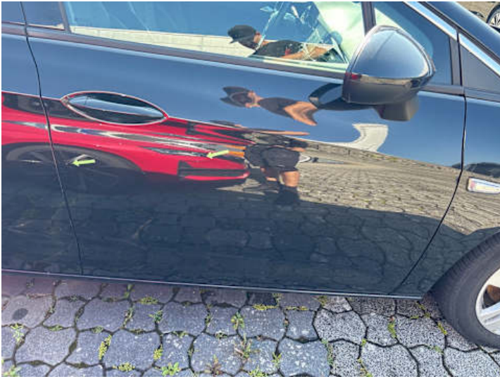
Beifahrtür (Kratzer, Lackschaden)
