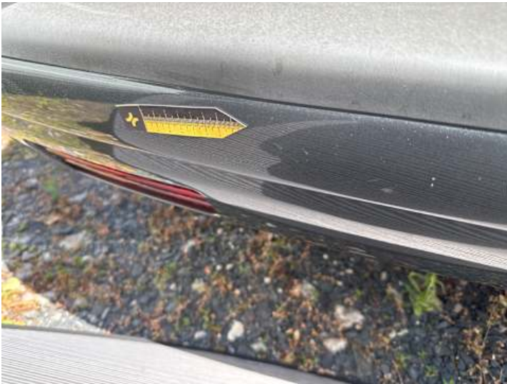
Stoßstange hinten (Lackschaden)
