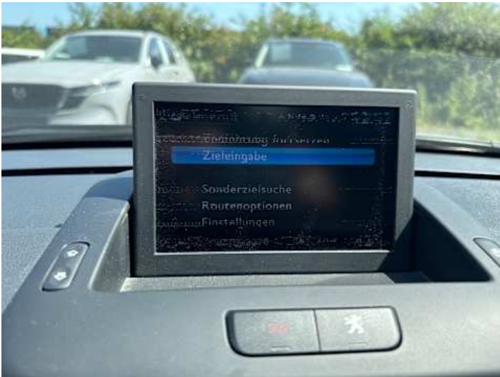
Innenraum (Anderer Schaden): Pixel fehler
