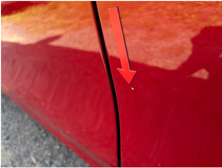
Türe hinten links (Lackschaden)
