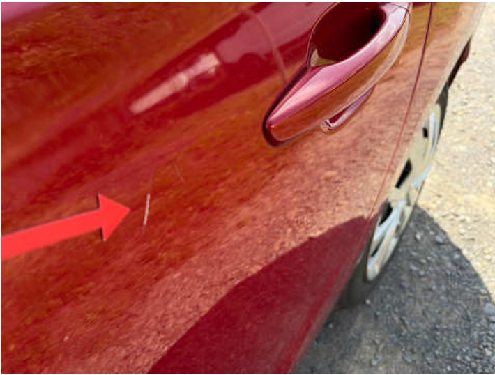
Türe hinten links (Lackschaden)
