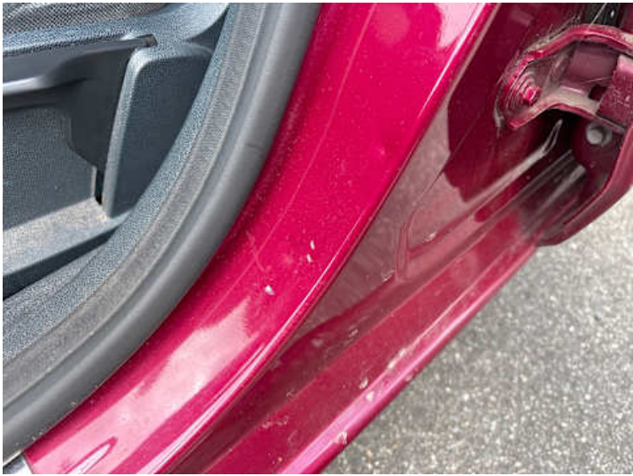
Schweller links (Lackschaden, Delle)
