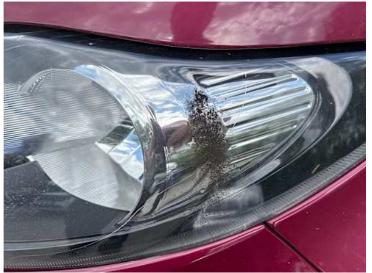
Scheinwerfer (links) (Anderer Schaden, Kratzer): Verschmutzung
