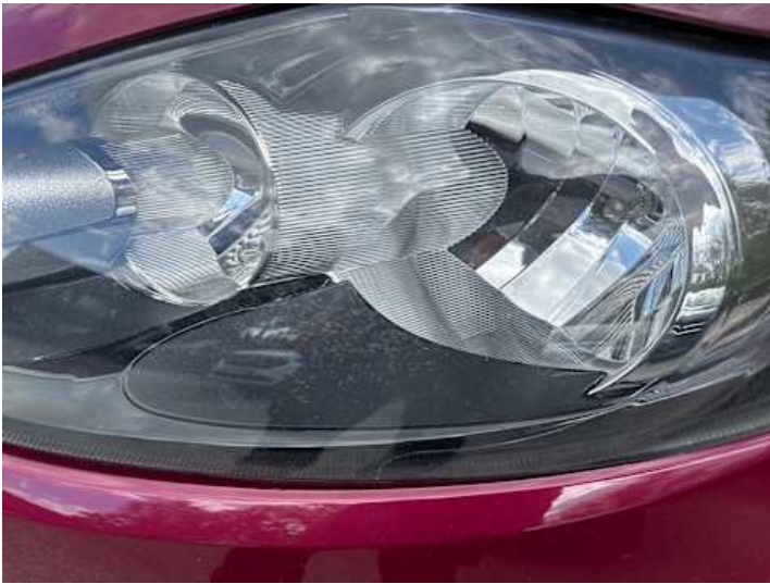
Scheinwerfer (links) (Anderer Schaden, Kratzer): Verschmutzung
