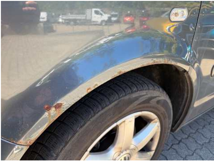
Kotflügel vorne links (Rost)
