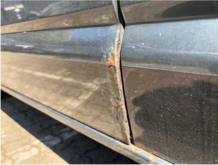
Türe hinten rechts (Rost)
