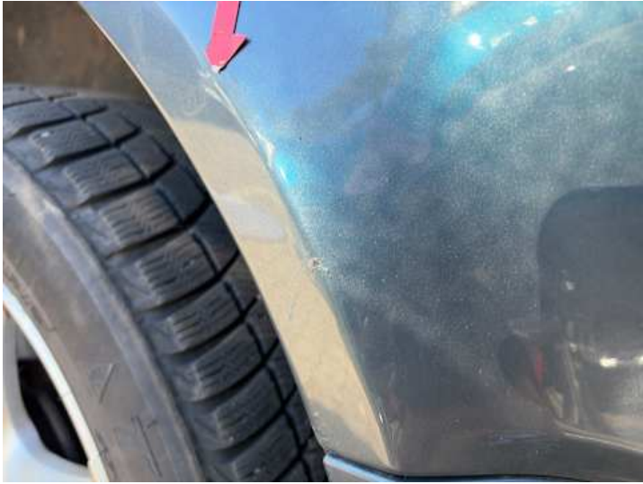
Seitenteil hinten links (Rost)
