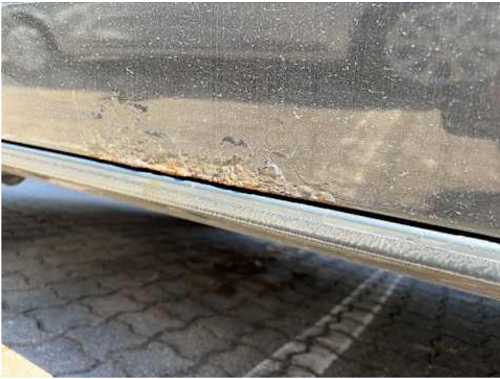
Türe hinten rechts (Rost)
