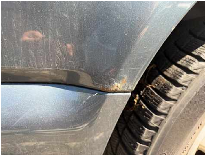
Seitenteil hinten rechts (Rost)
