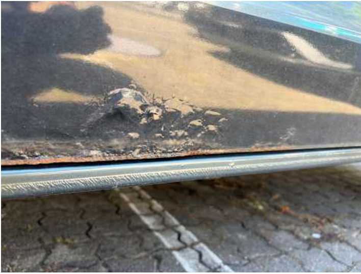
Türe hinten links (Rost)
