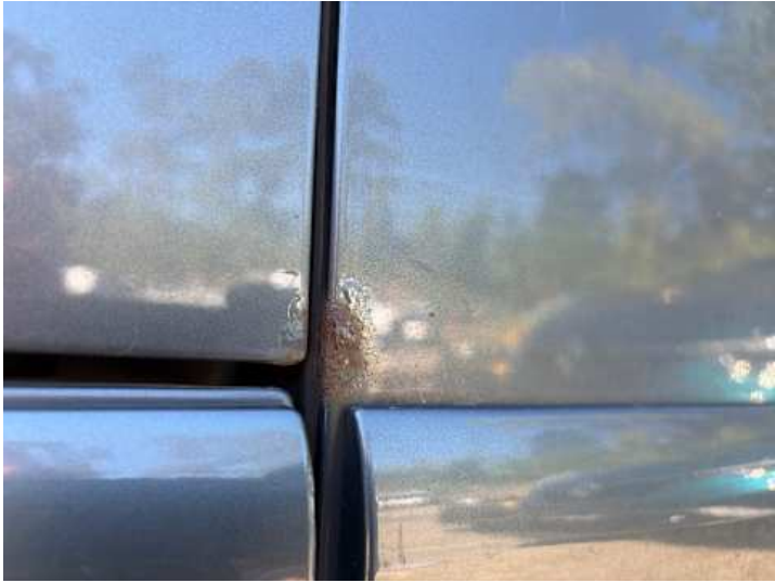
Türe hinten links (Rost)
