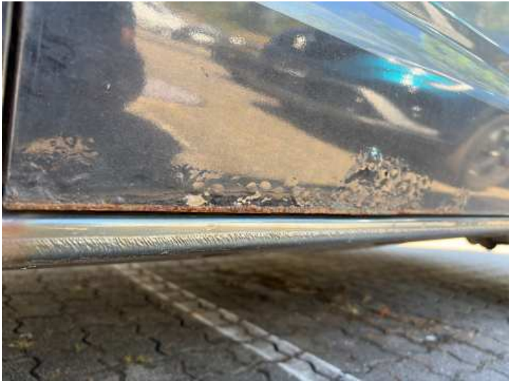
Türe hinten links (Rost)
