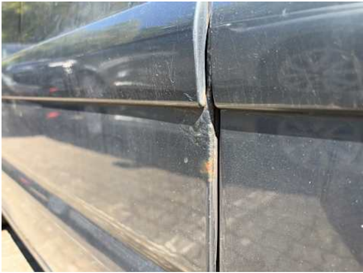
Türe hinten rechts (Rost)
