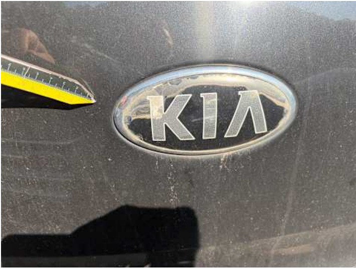
Heckklappe (Lackschaden, Kratzer)
