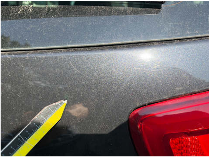
Heckklappe (Lackschaden, Kratzer)
