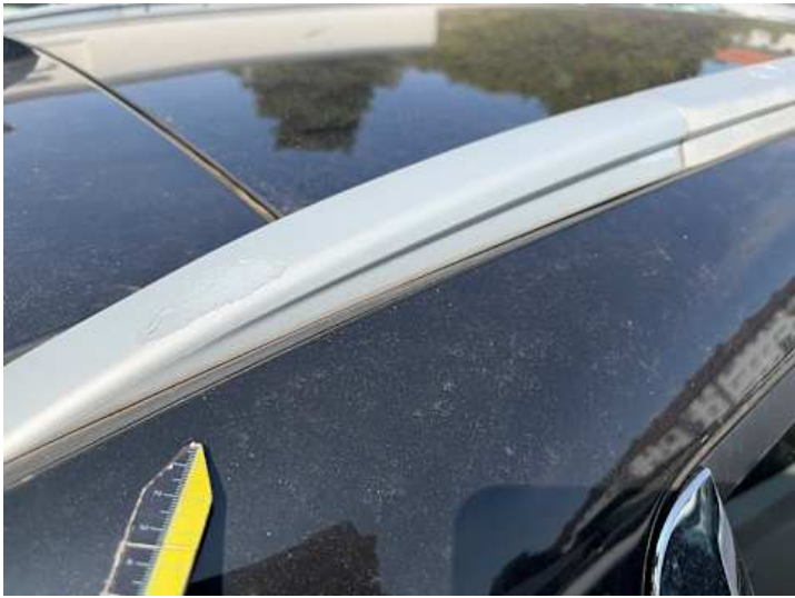
Dach (Lackschaden, Kratzer)
