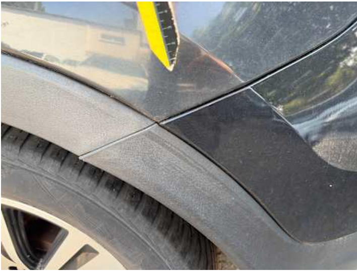
Stoßstange hinten (Spaltmaße ungenau)
