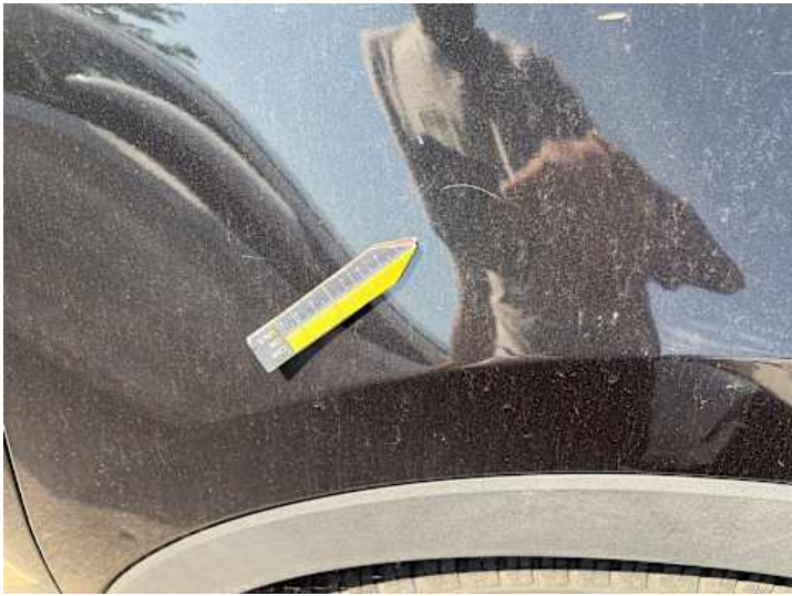
Kotflügel vorne rechts (Lackschaden, Kratzer)
