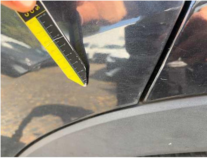
Türe hinten links (Lackschaden, Kratzer)
