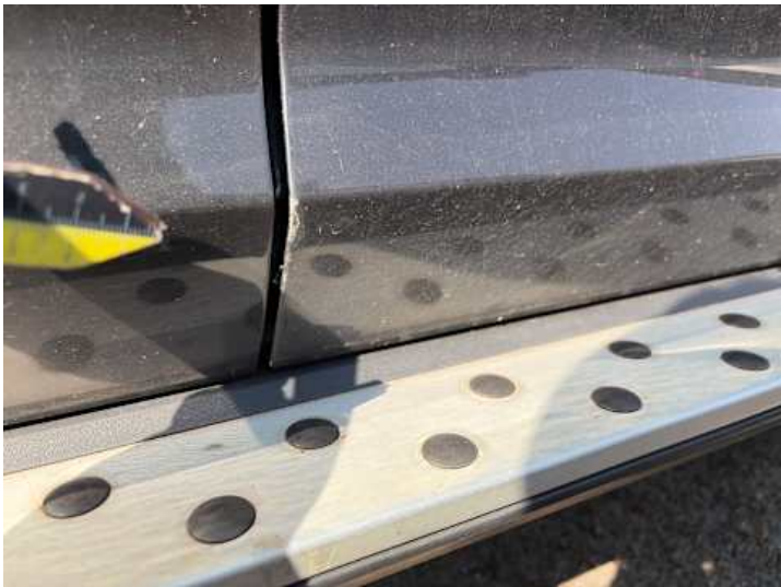
Beifahrtür (Lackschaden, Kratzer)
