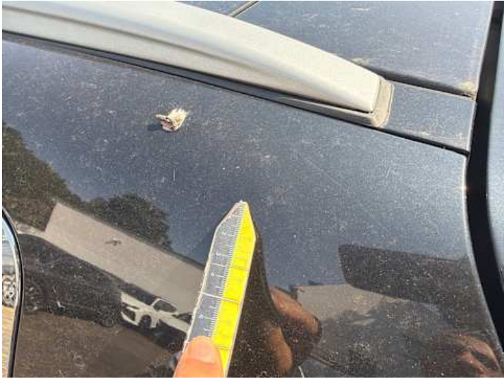
Dach (Lackschaden, Kratzer)
