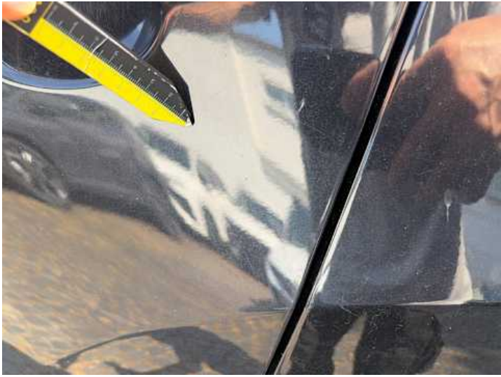
Türe hinten links (Lackschaden, Kratzer)
