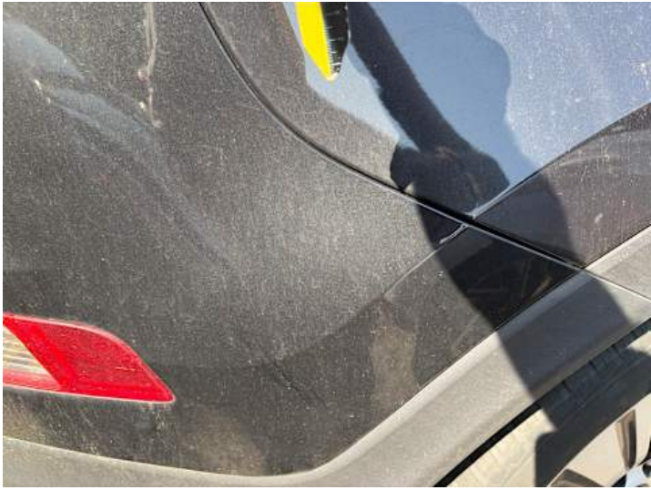
Stoßstange hinten (Spaltmaße ungenau)
