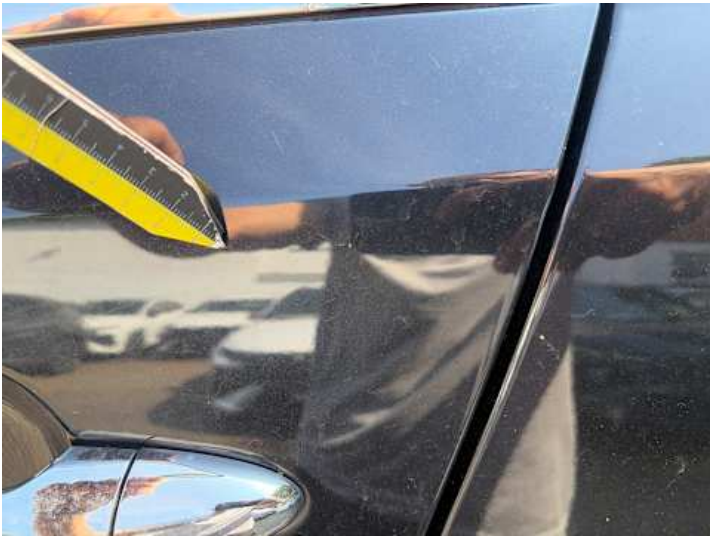
Türe hinten links (Lackschaden, Kratzer)
