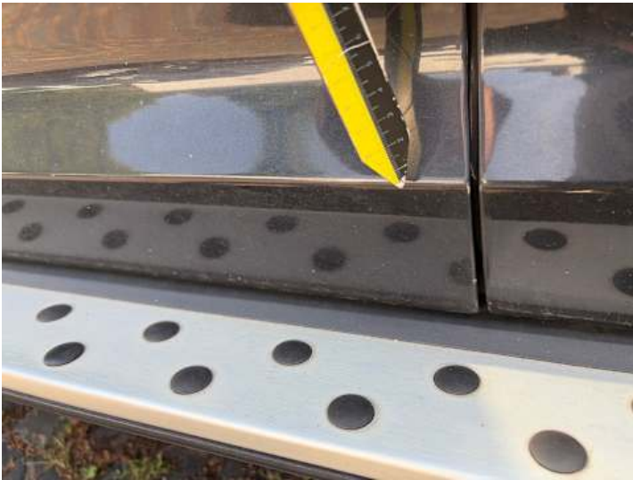
Fahrtür (Lackschaden, Kratzer)
