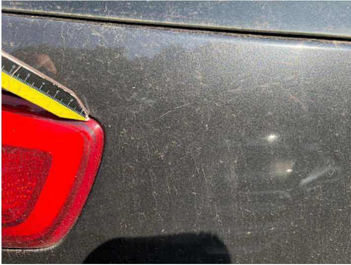
Heckklappe (Lackschaden, Kratzer)
