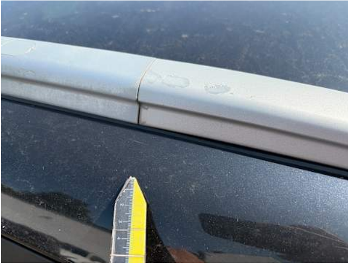
Dach (Lackschaden, Kratzer)
