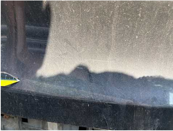
Heckklappe (Lackschaden, Kratzer)
