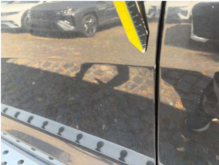
Fahrtür (Lackschaden, Kratzer)
