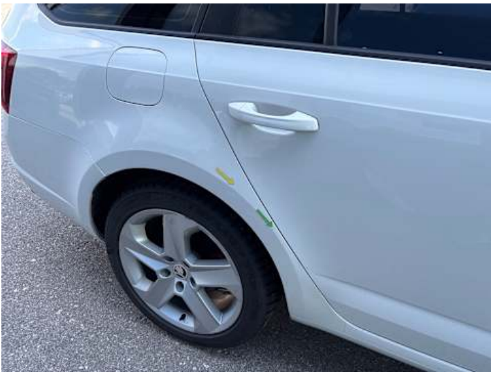
Seitenteil hinten rechts (Delle, Rost)
