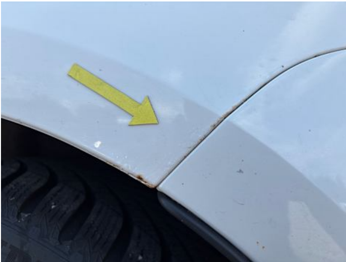
Seitenteil hinten links (Rost)
