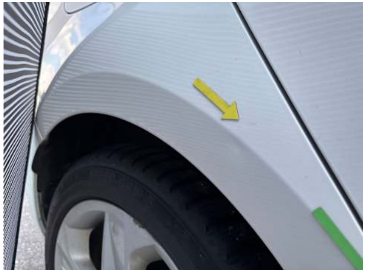
Seitenteil hinten rechts (Delle, Rost)
