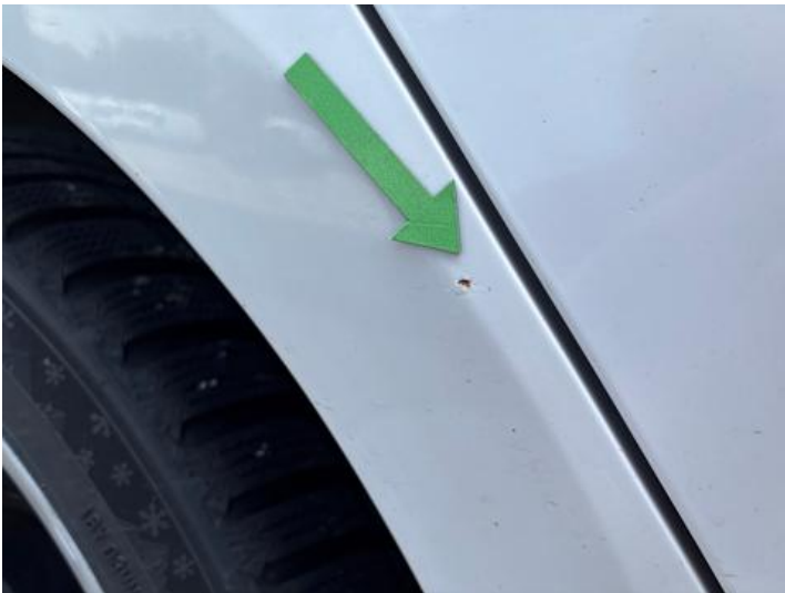
Seitenteil hinten rechts (Delle, Rost)
