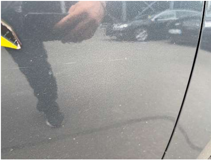
Beifahrertür (Lackschaden, Kratzer)
