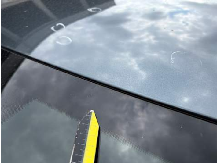
Dach (Lackschaden, Steinschlag)
