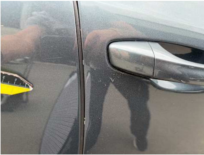
Beifahrertür (Lackschaden, Kratzer)
