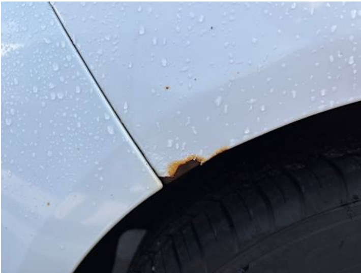
Seitenteil hinten rechts (Rost)
