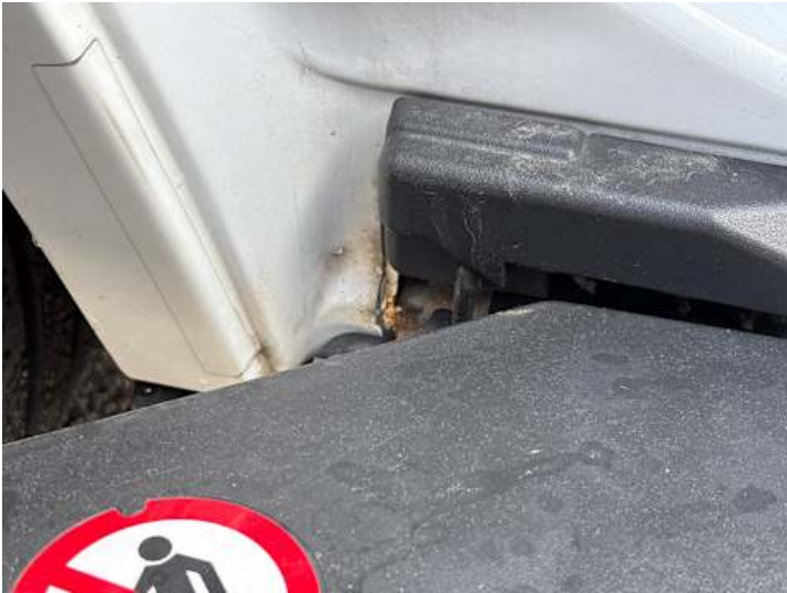
Schweller rechts (Rost)
