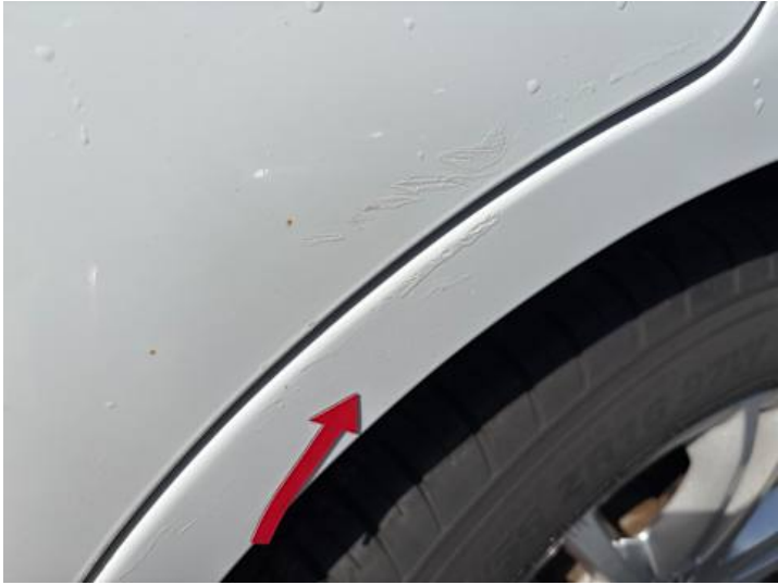
Seitenteil hinten links (Unsachgemäß instand gesetzt)
