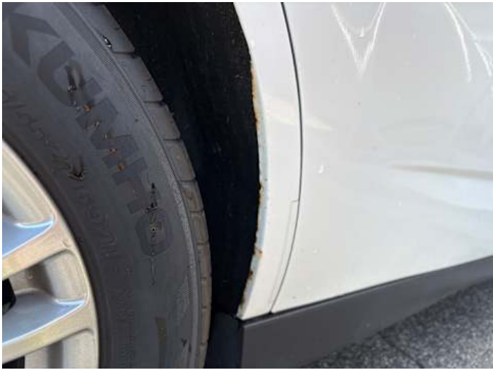
Seitenteil hinten rechts (Rost)
