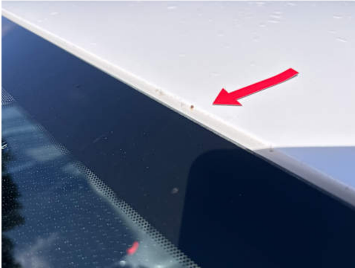
Dach (Rost, Steinschlag)
