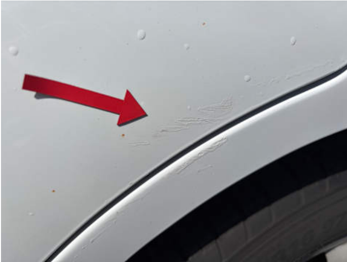
Türe hinten links (Kratzer, Unsachgemäß instand gesetzt)
