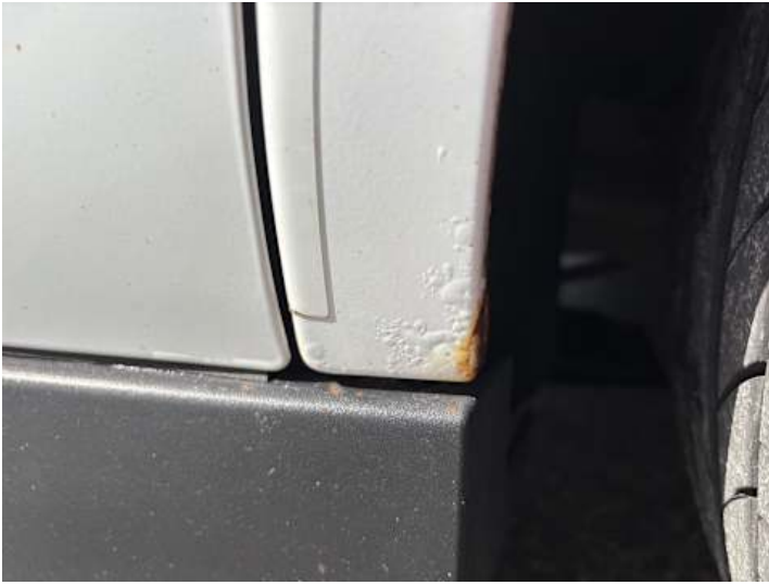
Seitenteil hinten links (Rost)
