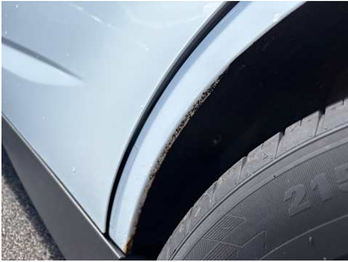
Seitenteil hinten links (Rost)
