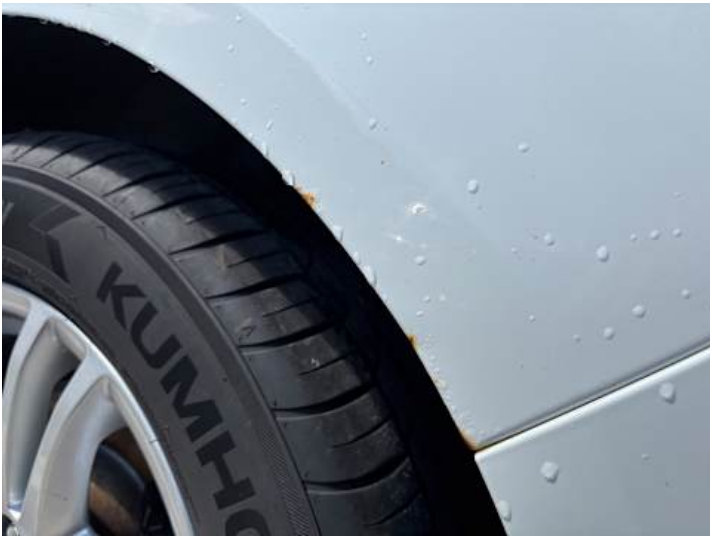
Seitenteil hinten links (Rost)
