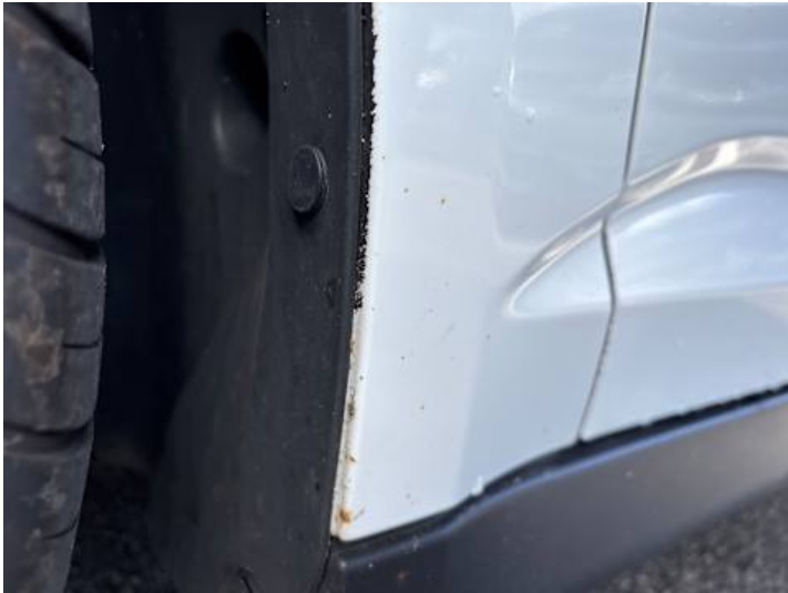
Kotflügel vorne links (Rost)
