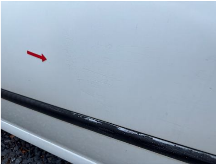
Fahrtür (Verformung, Kratzer, Unsachgemäß instand gesetzt)
