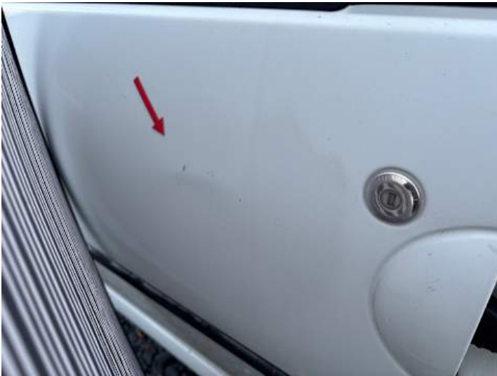
Fahrtür (Verformung, Kratzer, Unsachgemäß instand gesetzt)
