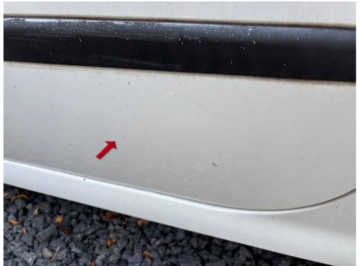
Fahrtür (Verformung, Kratzer, Unsachgemäß instand gesetzt)
