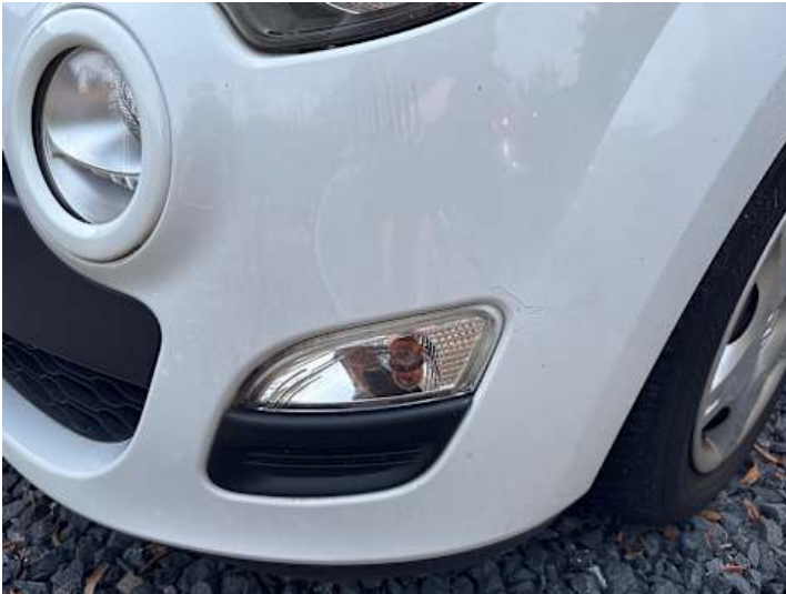
Stoßstange vorne (Lackschaden, Kratzer, Unsachgemäß instand gesetzt)
