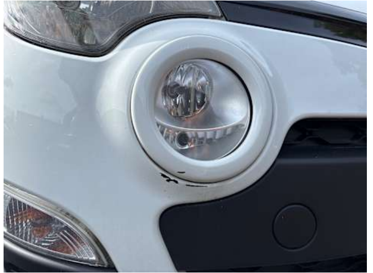
Stoßstange vorne (Lackschaden, Kratzer, Unsachgemäß instand gesetzt)
