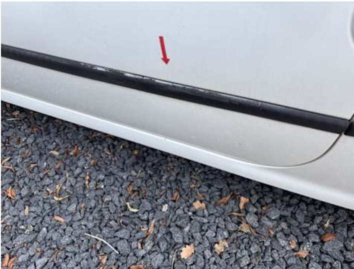
Fahrtür (Verformung, Kratzer, Unsachgemäß instand gesetzt)
