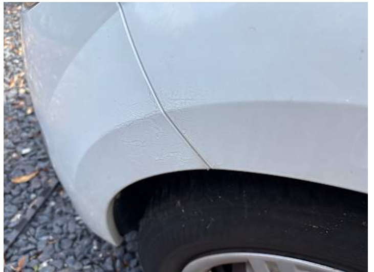
Kotflügel vorne links (Lackschaden, Kratzer, Unsachgemäß instand gesetzt)
