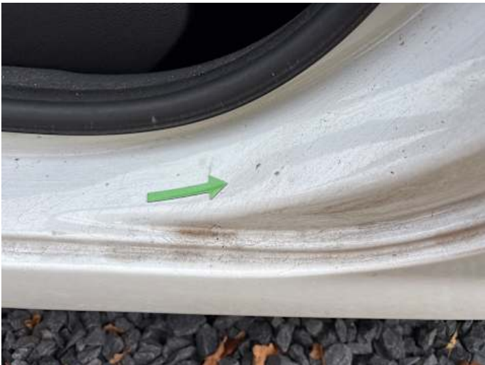
Schweller links (Delle, Kratzer)
