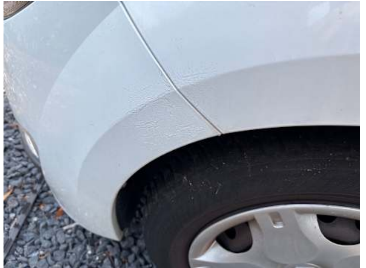
Stoßstange vorne (Lackschaden, Kratzer, Unsachgemäß instand gesetzt)
