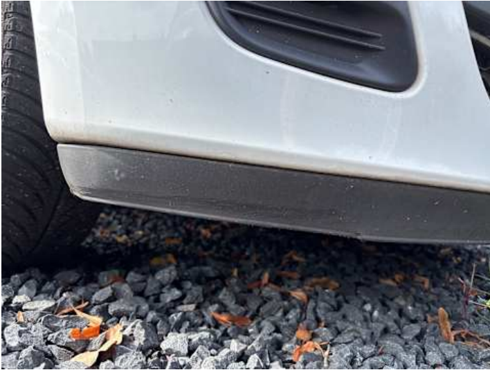
Stoßstange vorne (Lackschaden, Kratzer, Unsachgemäß instand gesetzt)
