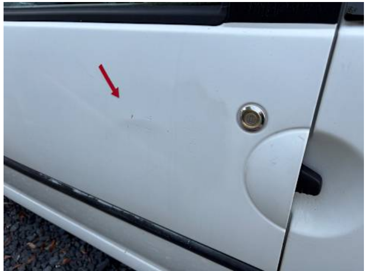
Fahrtür (Verformung, Kratzer, Unsachgemäß instand gesetzt)
