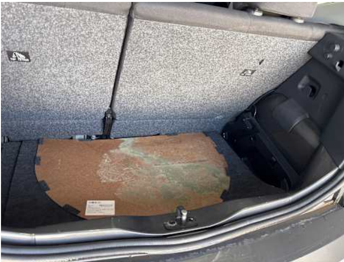
Innenraum (Anderer Schaden): Schimmelbildung
